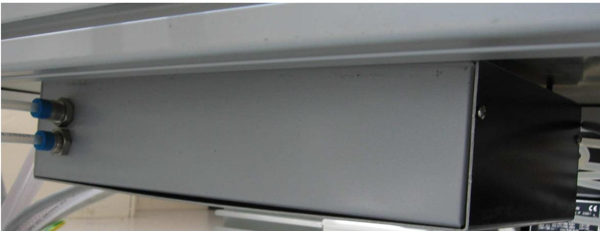
Figura 3.6: Vista frontale della scatola di derivazione contenente le elettrovalvole: sulla sinistra i due ingressi per l'aria compressa e l'azoto. La scatola si trova in posizione non ingombrante ed è montata sotto la macchina ed è facilmente estraibile.
