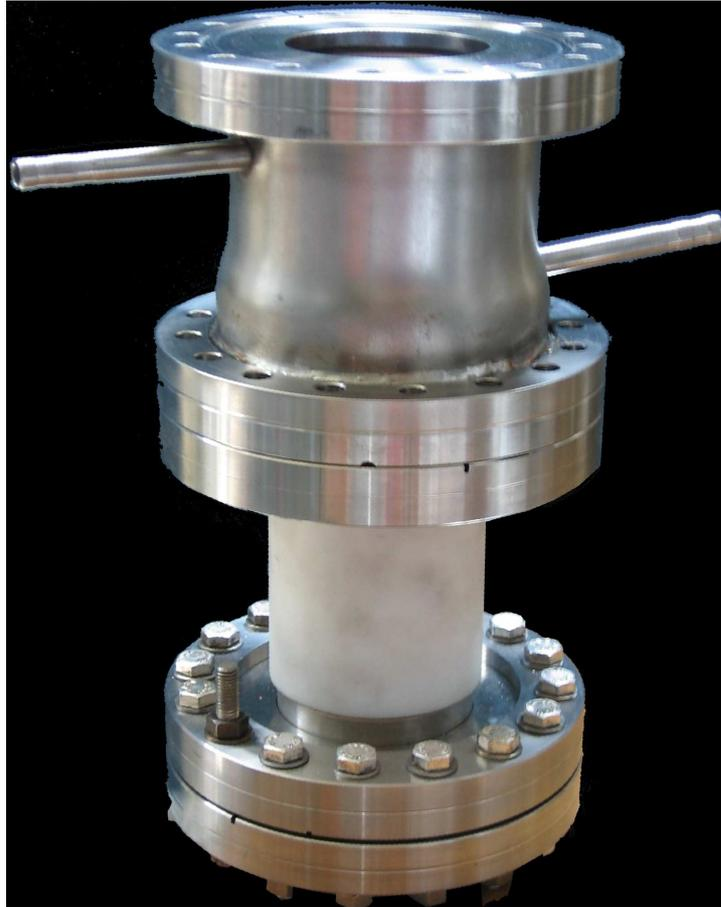
Figura 3.12: Sorgente ad arco da 2" assemblata con anodo raffreddato ad acqua.
