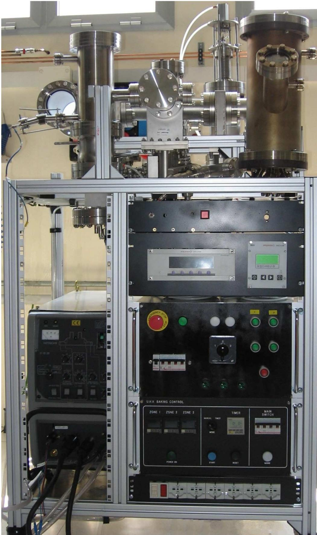
Figura 3.2: Sistema per deposizioni tramite arco (vista frontale) come si presenta al momento.
