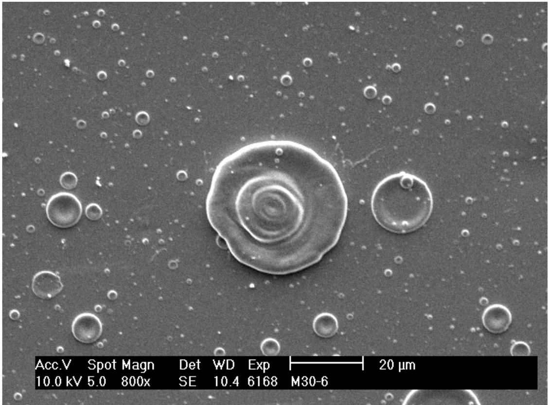
Figura 1.10: Fotografia al microscopio elettronico di macroparticelle di Cu su un film di Cu depositato tramite arco catodico pulsato.
