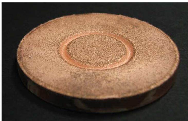
Figura 3.9: Target di Cu eroso.
