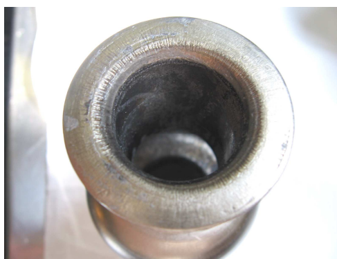
Figura 3.1 Fotografia di una cavità in cui si vedono le tipiche zone “puntinate”, dovute ad un'erosione non uniforme che si ha quando non vi sono le condizioni necessarie alla formazione del film viscoso.
