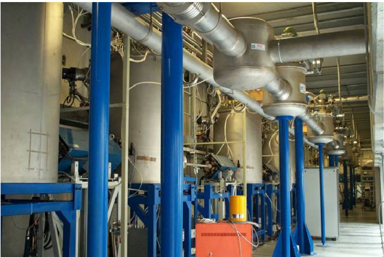
Figura 1-2: ALPI: acceleratore lineare presso i Laboratori Nazionali di Legnaro, INFN. Il sistema è costituito da cavità superconduttive in RF per l'accelerazione di ioni pesanti
