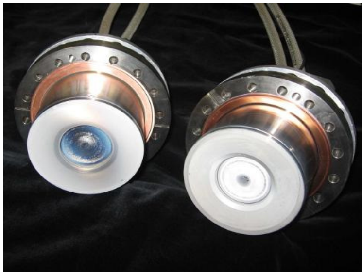
Figura 1-11: A sx magnetron planare con target di Nb, a dx magnetron planare con target di Sn
