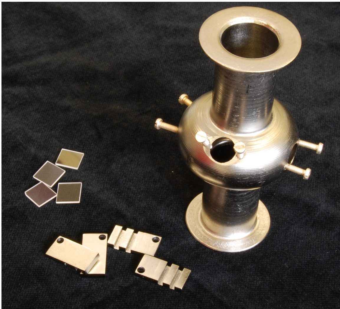
Figura 4-1: A dx si può vedere la cavità forata con le viti per l'ancoraggio dei campioni. Tale prototipo per lo sputtering è ancora in fase di studio, ma in questo modo sarà possibile sperimentare il processo di deposizione con una geometria che simula perfettamente la struttura risonante.
