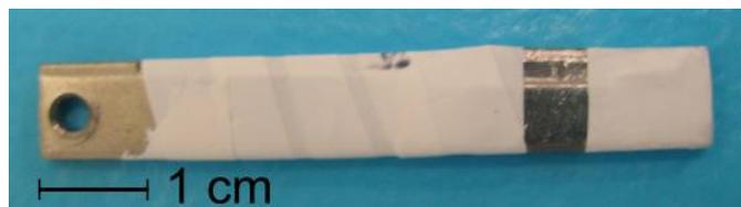
**Figura 3.4** – Catodo in niobio utilizzato per i processi di elettropulitura.
