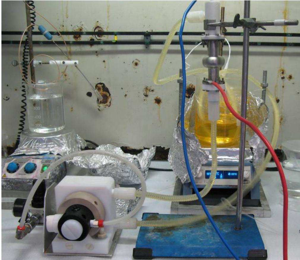
**Figura 3.25** – Apparato sperimentale usato per l'elettropulitura di cavità in flusso.
