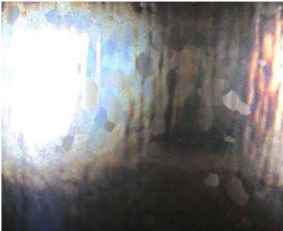
*Figura 4-32 Finitura interna della cavità di Nb dopo l'elettrolucidatura. Si notano i grani cristallini.*
