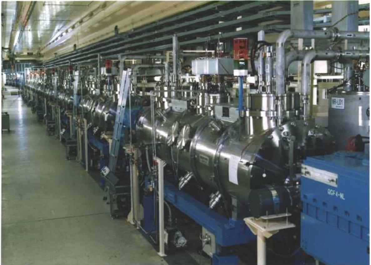
*Figura 1-3 Il sistema di accelerazione superconduttivo a KEK: le cavità giacciono all'interno dei criostati.*
