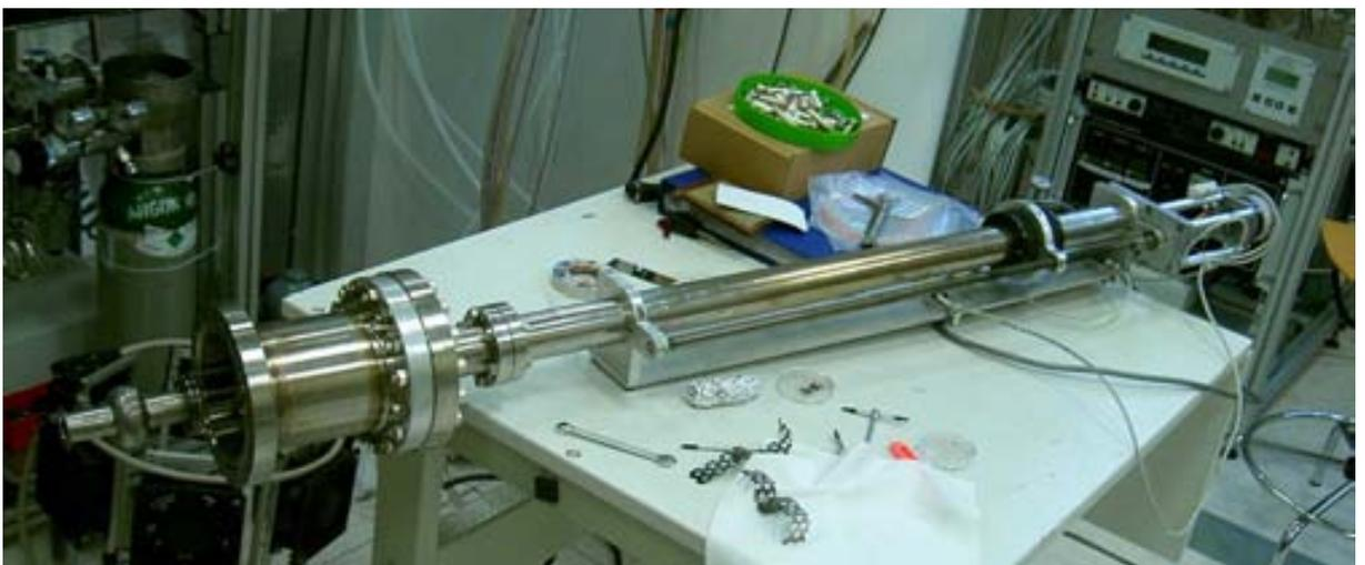
*Figura 4-27 Fotografia del passante lineare motorizzato durante una fase di montaggio della cavità all'estremità sinistra dell'asta. Il sistema di fissaggio lascia all'operatore un, seppur piccolo, grado di correzione dell'allineamento cavità – catodo.*
