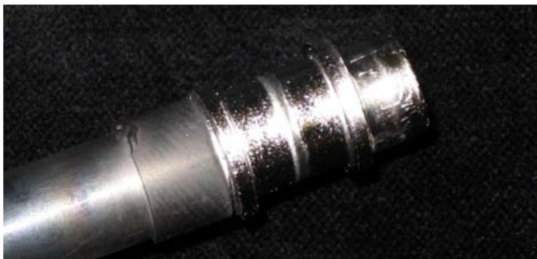
*Figura 4-24 Fotografia del target montato ed eroso dopo 6 ore di sputtering.*
