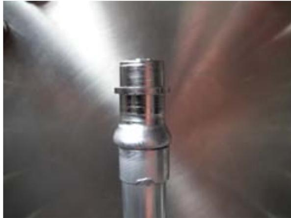
*Figura 4-31 Il target di Sn fuso e colato sul Nb e sullo schermo a massa.*
