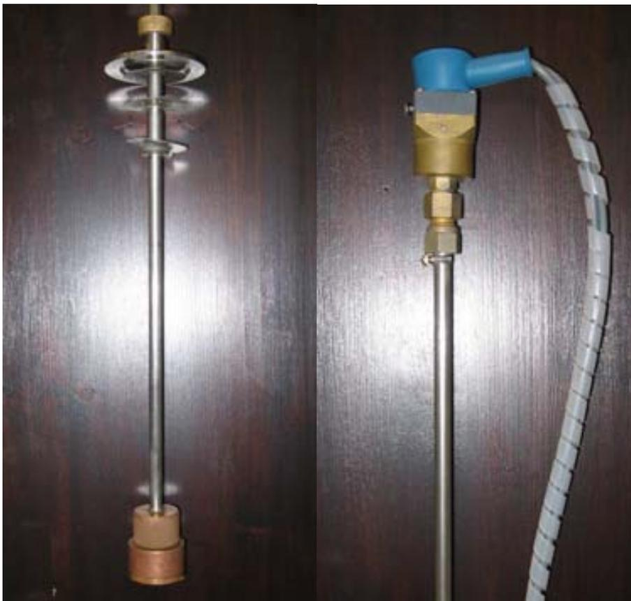
*Figura 3-2* Dettagli della sonda di misura. A sinistra in basso la testa di rame contenente il campione, le quattro punte, il termometro e la base di l'ancoraggio termico dei cavi, in alto la flangiatura KF 50. A sinistra l'estremità della sonda esterna al dewar.
