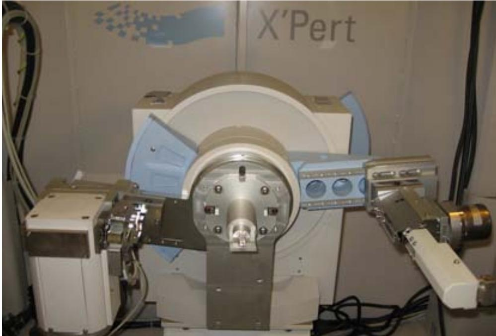
Figura 3-12 Il diffrattometro di Bragg “Philips X’Pert-Pro” utilizzato per l’analisi dei film sottili.
