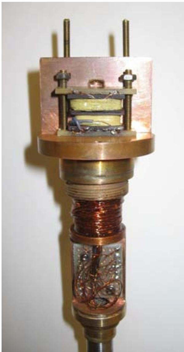
*Figura 3-10 Testa di misura assemblata. Si notano le due bobine in posizione con il campione tra esse, l'ancoraggio termico dei cavi e la piastrine dei contatti.*
