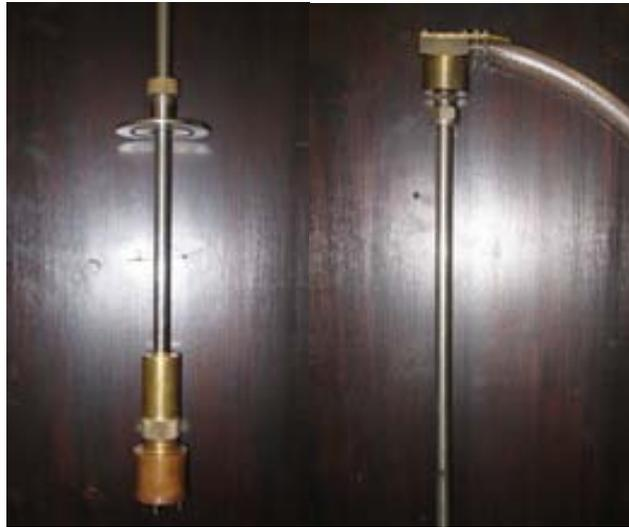
*Figura 3-8* Dettagli della sonda di misura. A sinistra in basso la testa di rame contenente il campione, le due bobine, il termometro e l'ancoraggio termico dei cavi, in alto la flangiatura KF 50. A sinistra l'estremità della sonda esterna al dewar.
