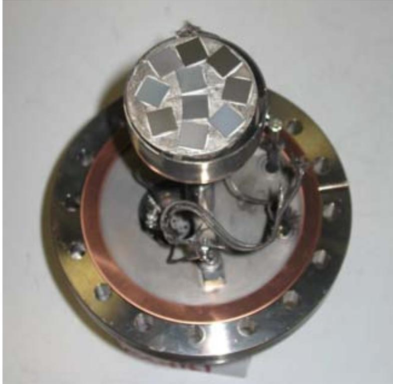
*Figura 4-4 Dettaglio del fornello con campioni fissati con pasta d'argento sul piatto riscaldato.*
