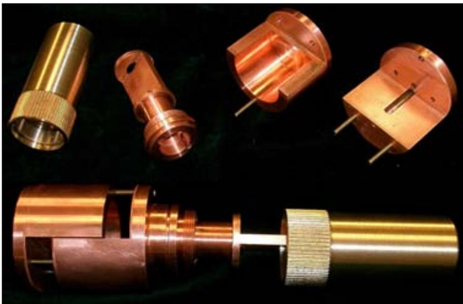
*Figura 3-9* Dettagli della testa di misura.
