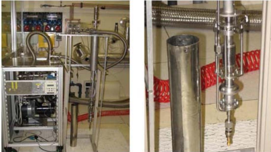
Figura 3-14 Il sistema di pompaggio per le misure in radiofrequenza, con lo schermo magnetico. A destra, particolare dell'assemblaggio della cavità.
