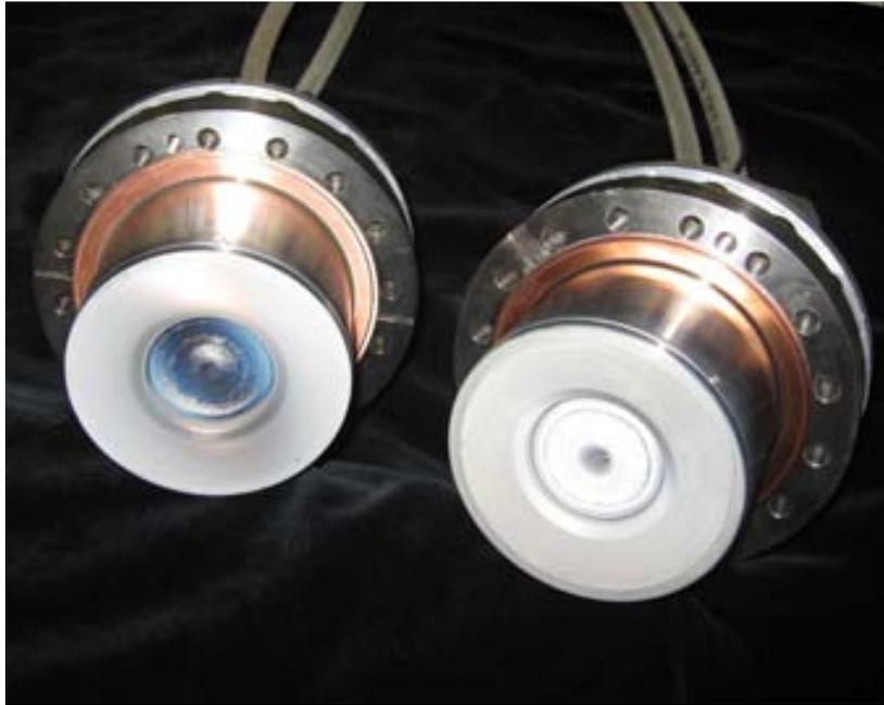
*Figura 4-1 Dettaglio dei due magnetron. Quello di sinistra monta un target di Nb, quello di destra monta un target di Sn.*
