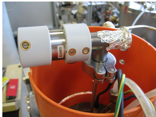
Fig.4.9c Dettaglio della valvola per la regolazione del vapore di idrocarburo immesso nell'ion gun.
