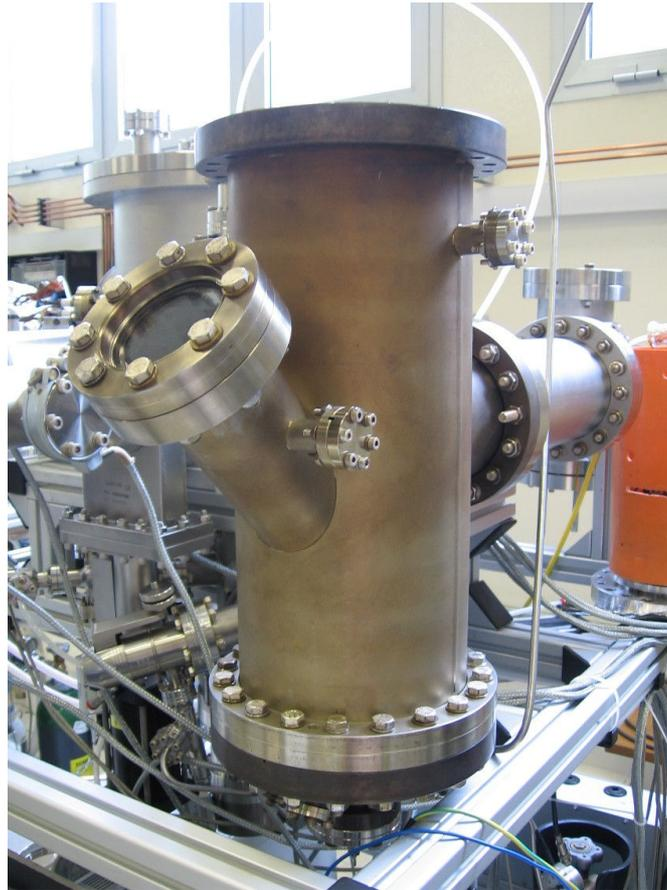
Fig.4.5b Esterno della camera di deposizione. La camera presenta un tubo obliquo saldato, con flangiato un oblò. Il pompaggio avviene attraverso il tubo visibile nella parte posteriore e collegato alla camera.
