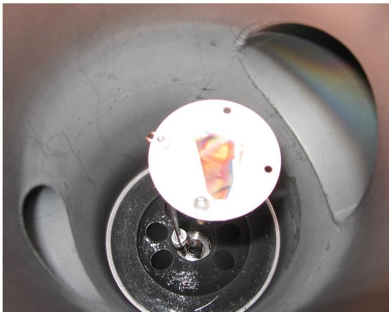
Fig.4.5a Interno della camera di deposizione ( con portacampioni isolato da massa del sistema)
