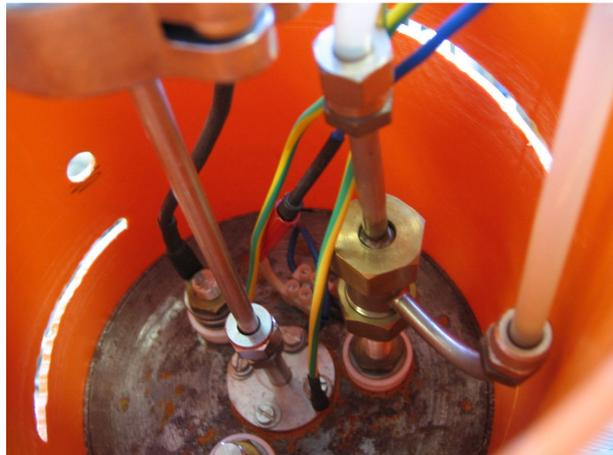
Fig.4.9 (a) A sinistra, viene presentata una foto dell'ion gun, predisposto con pannello cilindrico protettivo (arancio), valvola dell'ingresso del gas, tubi di raffreddamento e collegamenti d'alimentazione. L'ion gun è montato sopra la camera per la deposizione. La valvola rotonda che si vede in alto serve alla regolazione del flusso del gas di processo inserito in camera
