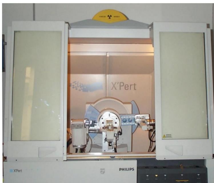
Fig. 8.2- Diffrattometro.
