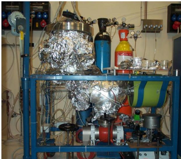
Fig. 6.10- Sistema da modificare per la deposizione di film multistrato .
