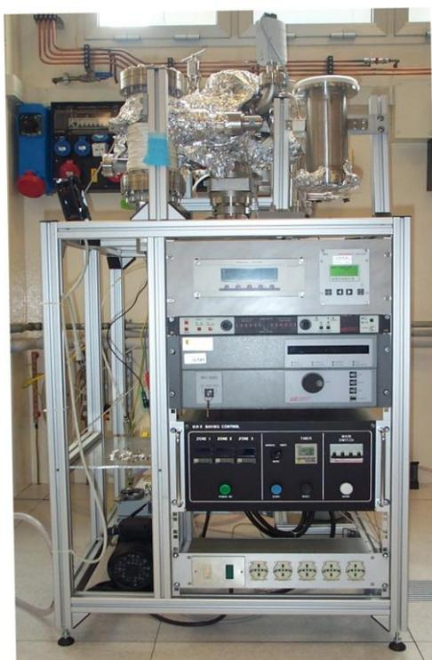
Fig. 7.1- Sistema da vuoto a quattro camere utilizzato per la deposizione di film del sistema Mo-Re.
