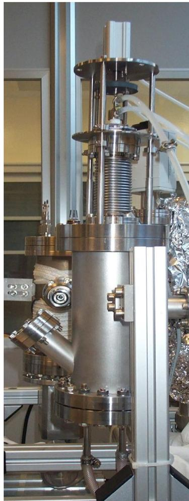
Fig. 6.2- Immagine della fornace ad arco ideata per la fabbricazione di piccoli campioni di **A15** bulk
