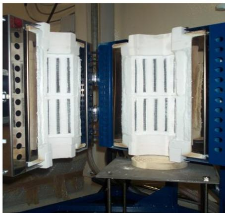
Fig. 6.5- Forno utilizzato per portare il sistema alla elevata temperatura di processo (circa  $1000^{\circ}\text{C}$ ).
