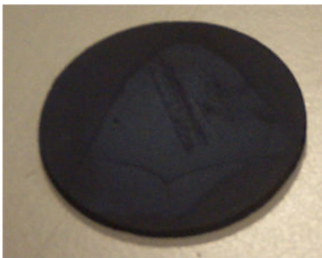
Figura 5.13: Target prodotto da polveri di \text{MgB}_2 a 200 tonnellate.
