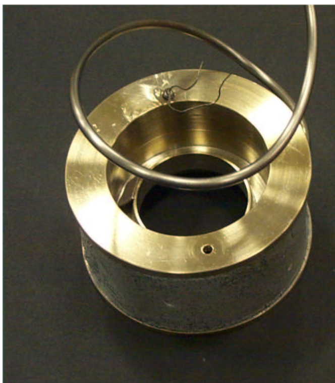
Figura 6.11: Fornetto per lo sputtering in atmosfera di magnesio. Nella cava viene inserita la polvere di magnesio da fare evaporare
