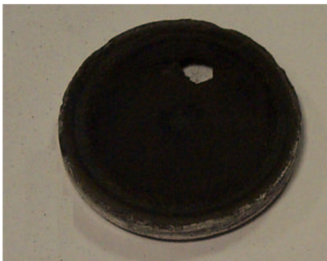
Figura 5.7: Target sovrestechiometrico ( 2\text{Mg}+\text{MgB}_2 ) dopo sputtering ad alte correnti
