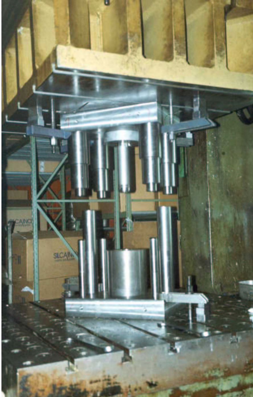
Figura 5.14: Macchina per pressatura uniaxiale con matrice corazzata multistrato.
