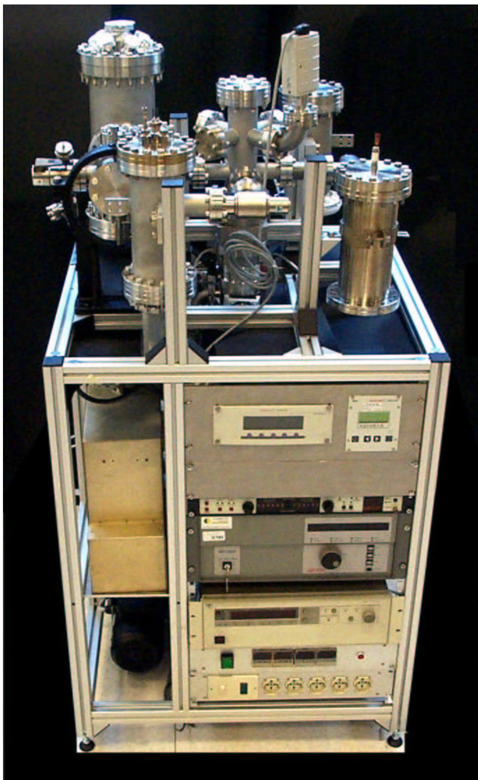
Figura 4.1: Camera progettata e utilizzata per la produzione dei film
