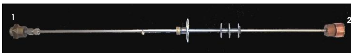
Figura 5-11: Visione di insieme della sonda di misura. 1: parte collegata al rack, 2: parte da inserire nel dewar contenente azoto liquido.
