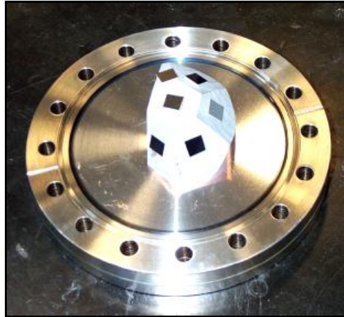
Figura 4-10: Porta substrati di quarzo utilizzato per variare sistematicamente l'angolo di deposizione e montato su flangia cieca CF 100 27 .
