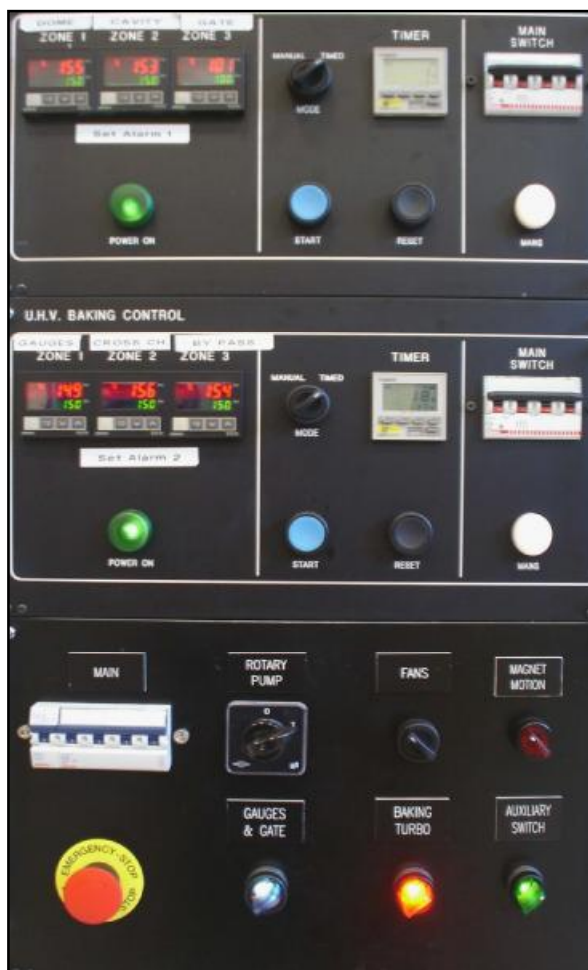
Figura3-8: Particolare delle due scatole UHV BAKING CONTROL e della scatola di derivazione principale.
