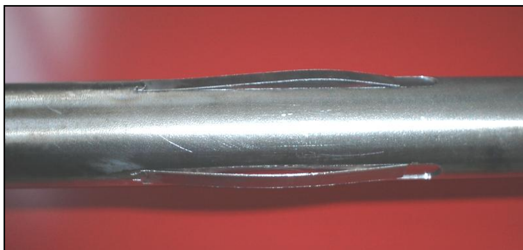
Figura 3-5: Particolare delle linguette in acciaio costruite per garantire il contatto elettrico tra tubo in acciaio e target di niobio.
