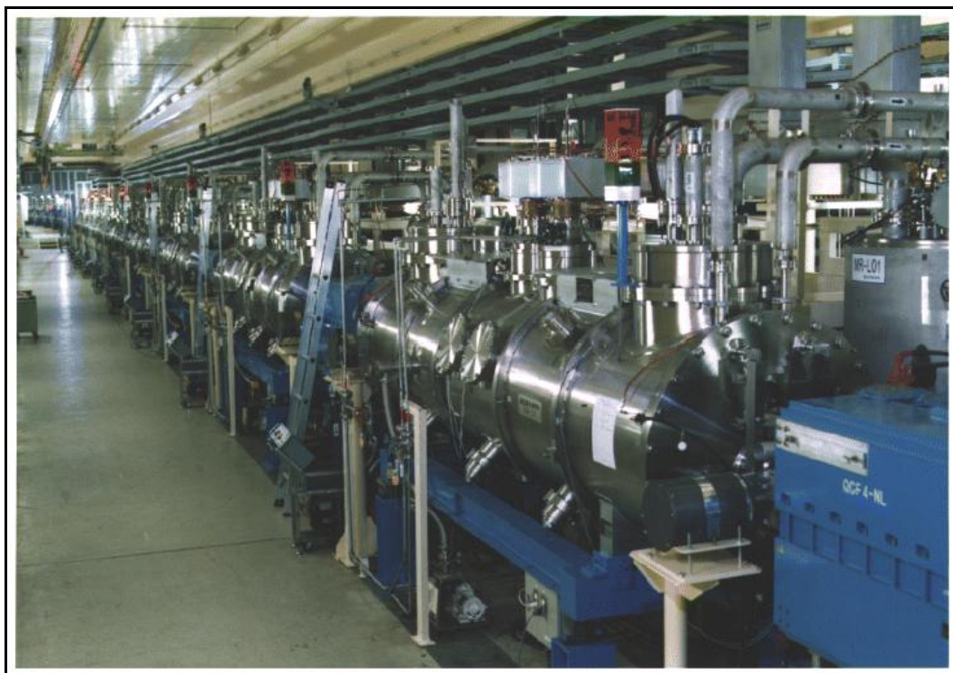
Figura 1-3: Fotografia di un sistema di accelerazione superconduttivo a KEK: le cavità giacciono all'interno del grande criostato 3 .
