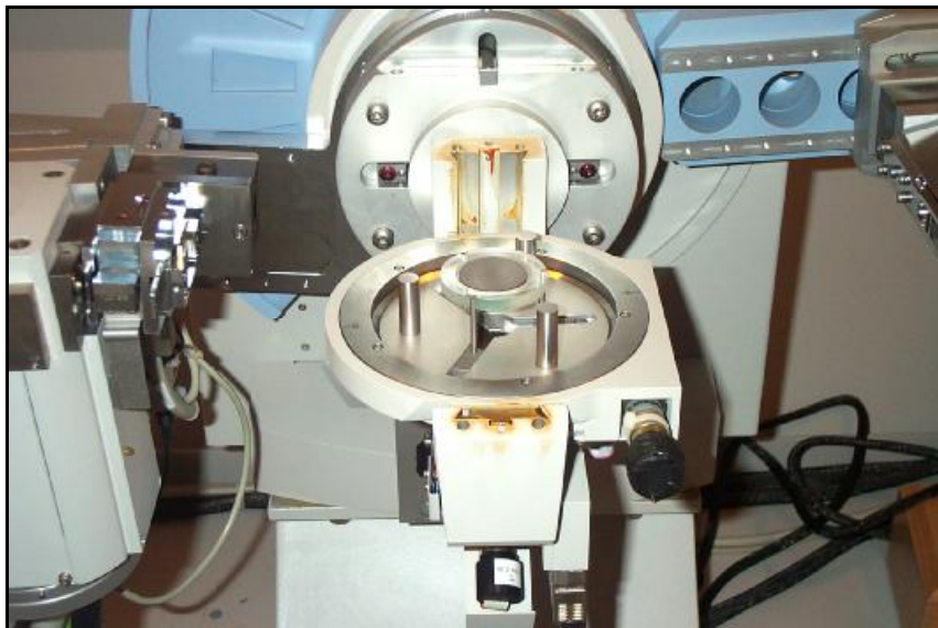
Figura 5-23: Culla di Eulero per misure di tessiture.
