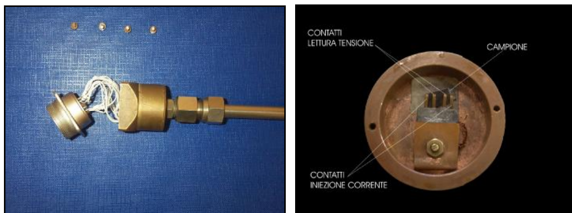
Figura 5-10: A sinistra foto della testa di misura, a destra particolare del posizionamento del campione al suo interno.
