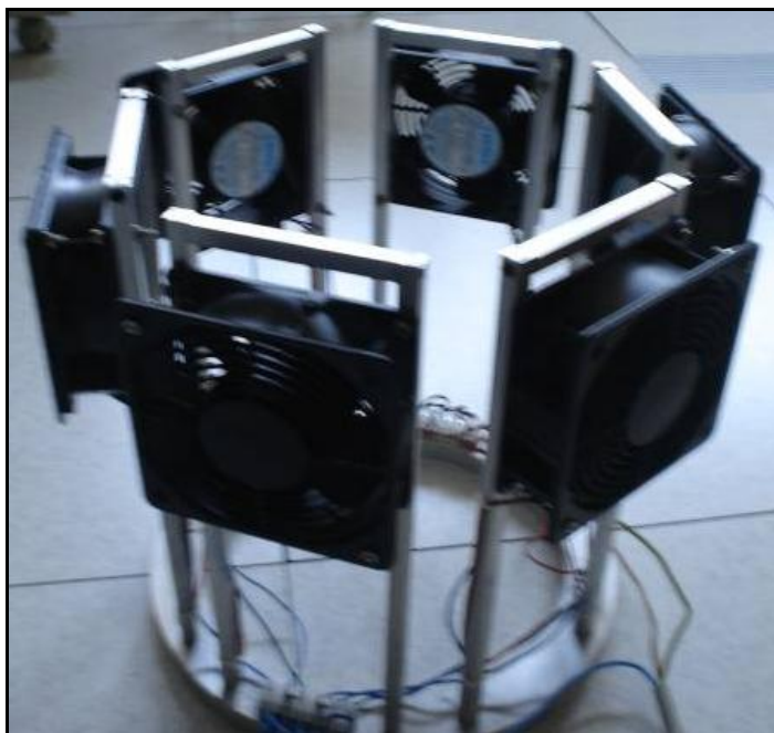
Figura 3-13: Ventilatori per il raffreddamento della cavità durante le deposizioni.
