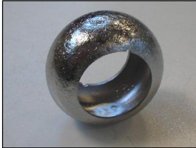
Figura 4-20: Foto dell'anello di niobio per il catodo sagomato.
