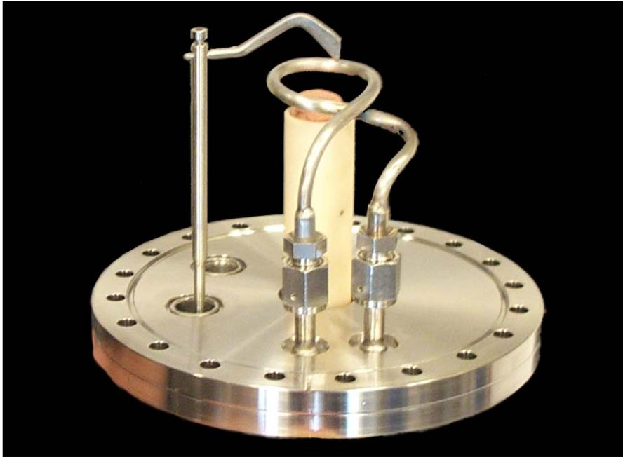
Figura 2.7: Sorgente per arco catodico interamente assemblata su una flangia CF150. In primo piano si può osservare l'anodo circolare, raffreddato ad acqua, che si avvolge sul catodo. Sulla sinistra il trigger con la punta in Nb
