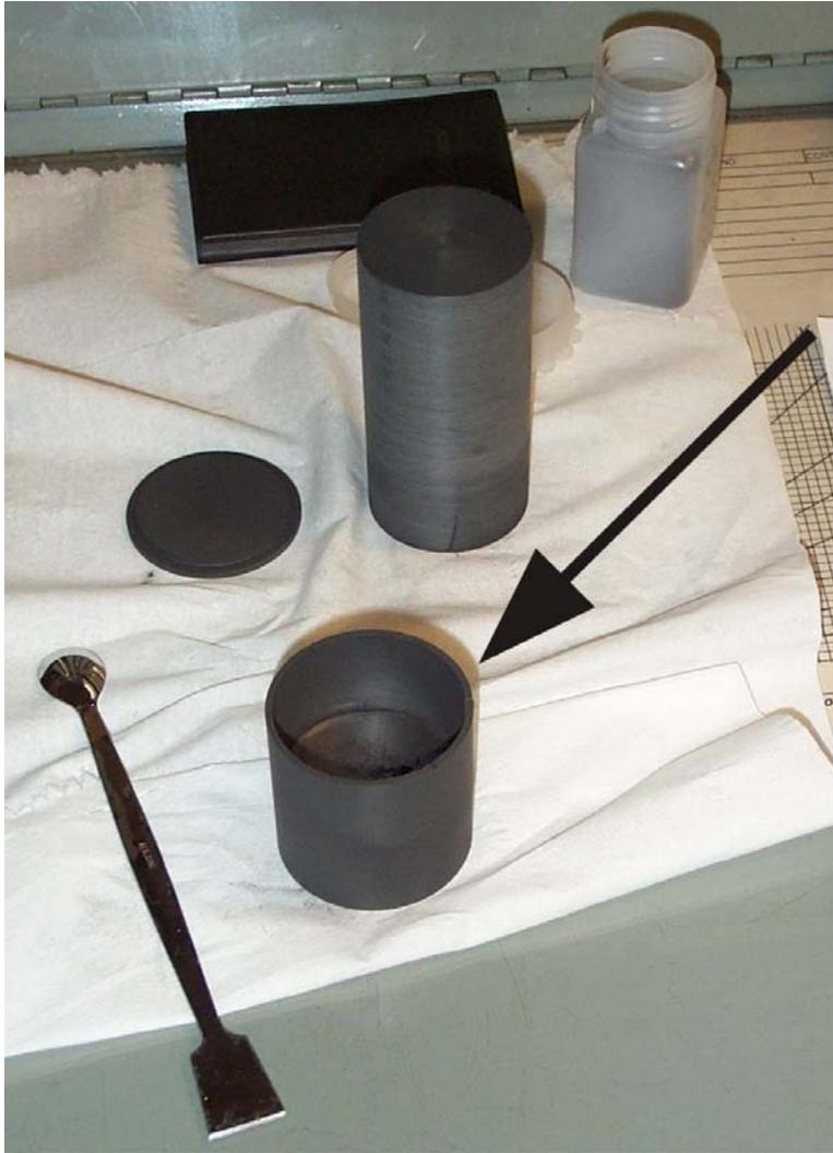
Figura 6.10: Crogiuolo in grafite utilizzato per la pressatura isostatica a caldo.
