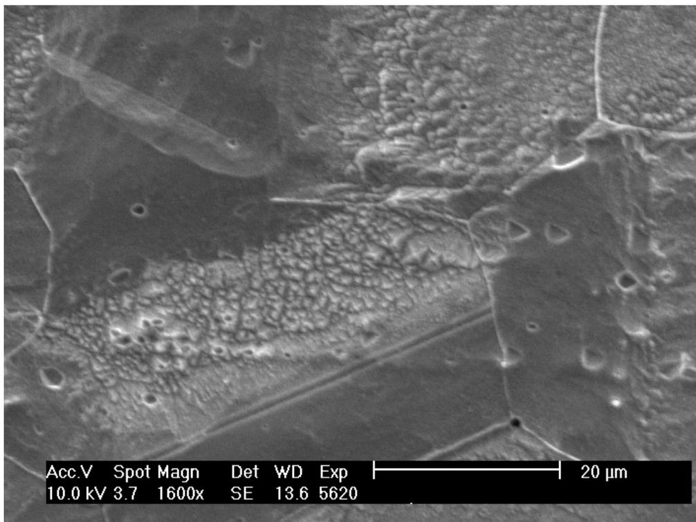
Figura 7.6: : Finitura superficiale del substrato in acciaio AISI 316L dopo il processo di sbavatura
