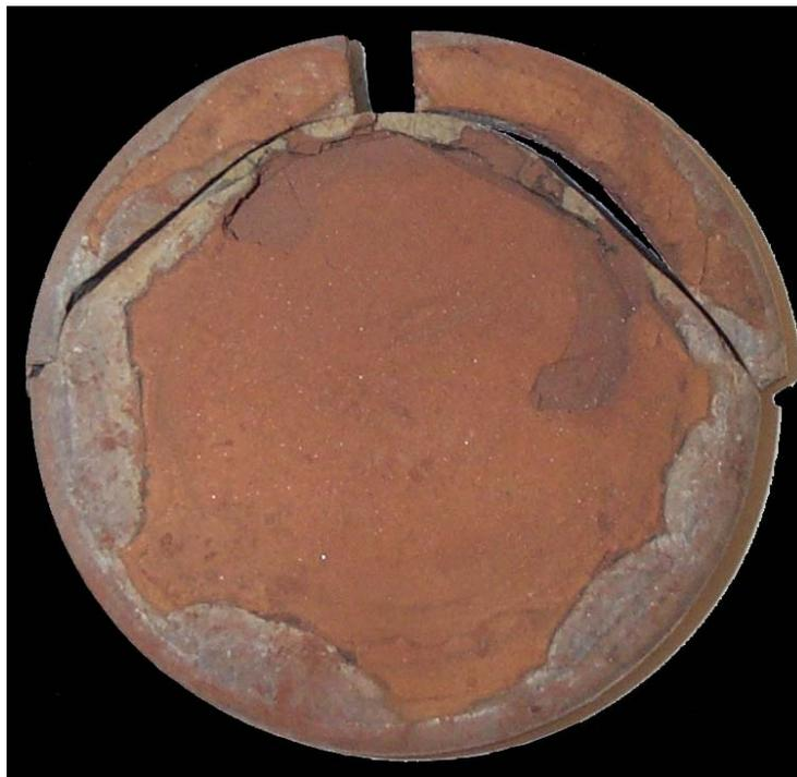
Figura 6.17: Target **HIP3** sinterizzato per pressatura isostatica a caldo
