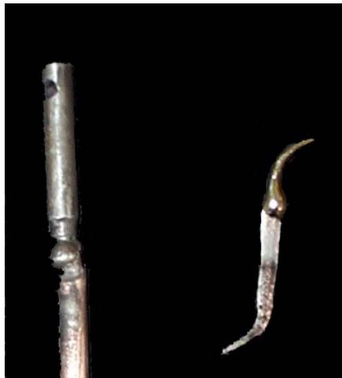
Figura 2.8: Sulla destra: punta in Nb fusa. Sulla sinistra: asta in acciaio, che sostiene la punta in Nb, fusa dalle elevate correnti.
