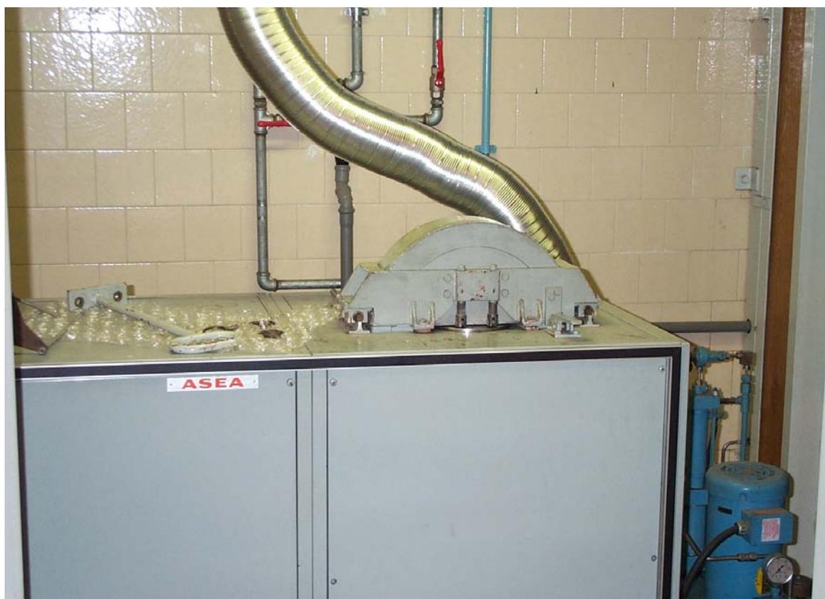
Figura 6.9: Pressa isostatica a caldo utilizzata presso il centro ricerche Venezia Tecnologie (gruppo ENI).
