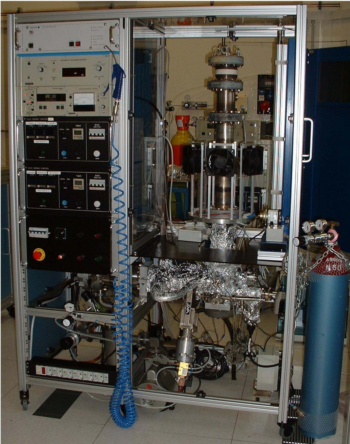
Figura 0.7: Il sistema da sputtering utilizzato per le deposizioni
