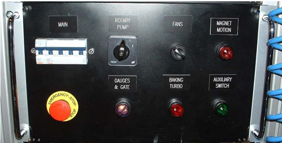
Il sistema necessita di svariate apparecchiature alimentate a corrente, soprattutto pannelli di controllo della pompa turbomolecolare, lettori di gauges, e il pannello di apertura, chiusura e interlock della gate. Per una questione di praticità, ma soprattutto di sicurezza, si è pensato di convogliare tutte le prese degli strumenti ad un'unica scatola di derivazione.
