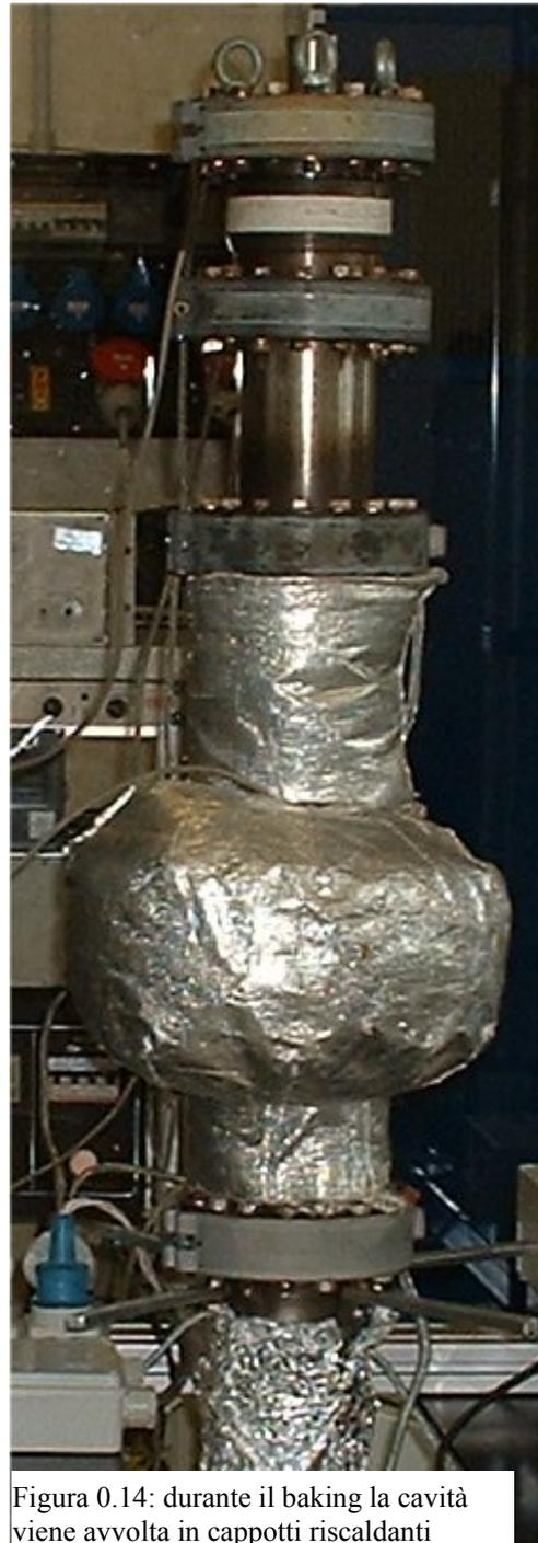
Figura 0.14: durante il baking la cavità viene avvolta in cappotti riscaldanti
