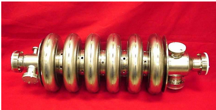
Figura II.9 - Esempio di cavità ( \beta = 0,81 ) realizzata interamente al Jlab per stampaggio da lastra in niobio. L'intera struttura, oltre alle celle e agli anelli di stiffening, comprende anche una serie di flangie e porte laterali.
