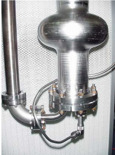
Figura III.20 - Particolare della flangia inferiore per una cavità monocella a 1.5GHz. Il cavo porta il segnale in ingresso della radiofrequenza, mentre il tubo laterale è connesso alla linea di vuoto.
