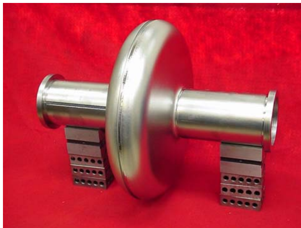
Figura II.8 - una cavità monocella saldata per EBW. La zona equatoriale, il punto di contatto con il condotto del fascio e le flange esibiscono tutte il tipico aspetto liscio e e lucido caratteristico di questo tipo di tecnica di saldatura.
