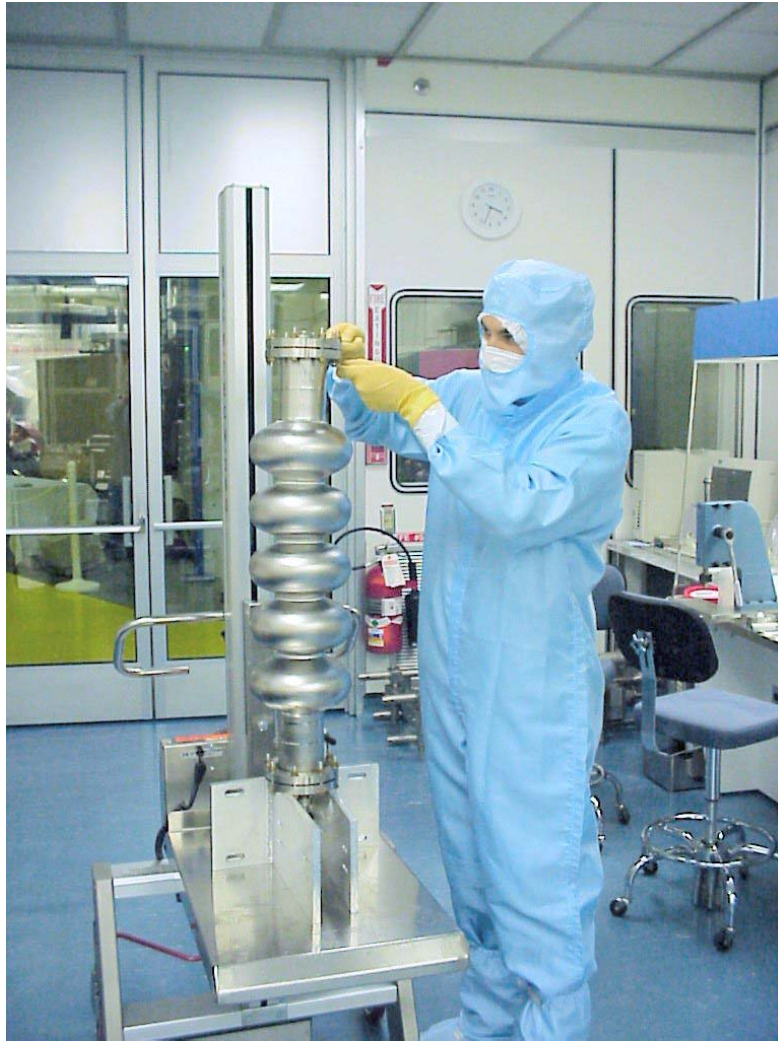
Figura III.19 - Il candidato mentre monta in camera bianca una cavità multicella a 1.5GHz.
