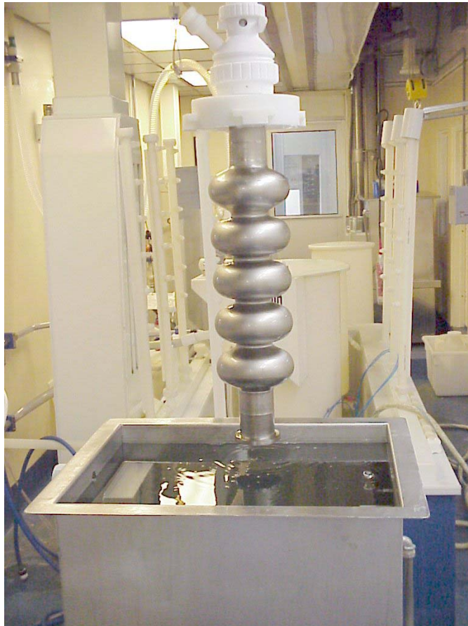
Figura III.10 - Trattamento di sgrassaggio ad ultrasuoni di una cavità multicella.
