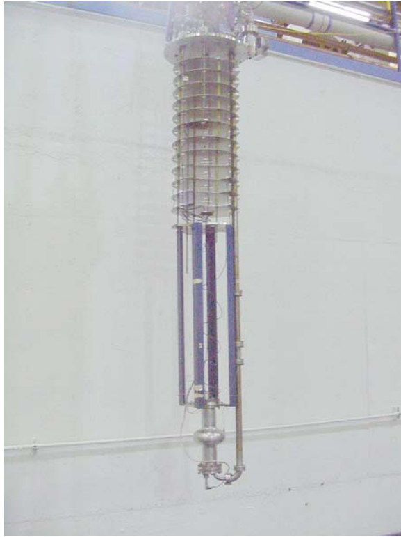
Figura III.21 - Dettaglio sul supporto di sostegno per l'inserimento della cavità nel dewar di elio. I piatti sistemati sopra la cavità servono per schermare il bagno d'elio dalla temperatura esterna.
