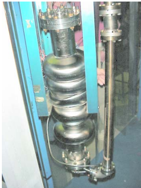
Figura IV.8 - Foto dell'implosione della cavità P5C in seguito al collegamento con la linea ad alto vuoto.
