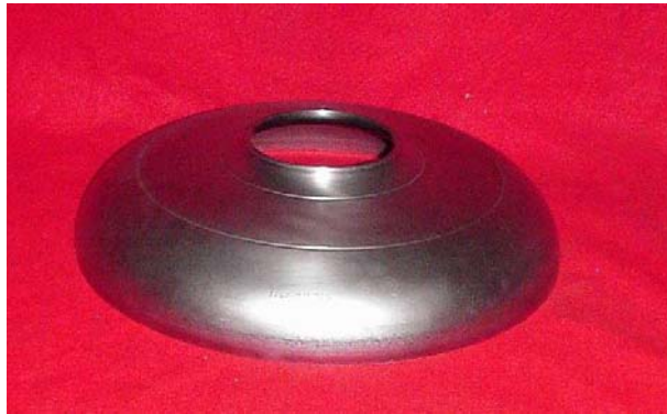
Figura II.6 - Esempio di semicella realizzata al Jlab per stampaggio, alla fine dell'operazione di rettifica meccanica.
