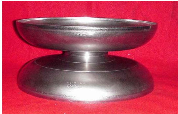
Figura II.7 - Esempio di DumbBell prima della saldatura sulla zona dell'iride della cavità. Sulla parte superiore si nota lo scalino realizzato per incastrare le celle.
