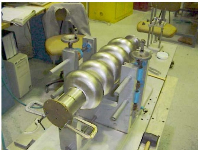
Figura III.9 –Sistema di tuning per una cavità a cinque celle con frequenza di risonanza a 1.5 GHz.
