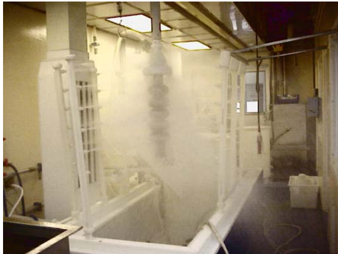
Figura III.11 - Operazione di risciacquo della cavità
