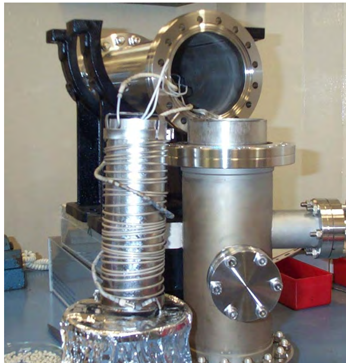
Figura 3-7 – Foto del tubo di titanio prima dell'inserimento nella camera di pompaggio. Il tubo di titanio è a sua volta inserito all'interno di un tubo di inconel. Dalla flangia CF100 in alto giungono i cavi di alimentazione della corrente e delle termocoppie.
