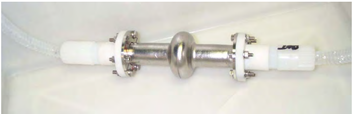
Figura 3-4 – Foto delle connessioni delle flangie per la cavità durante il trattamento chimico.
