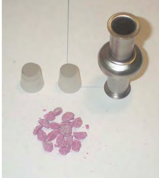
Figura 3-2 – Foto di una cavità e del materiale per la burattatura. Il materiale abrasivo è costituito da scaglie di allumina.
