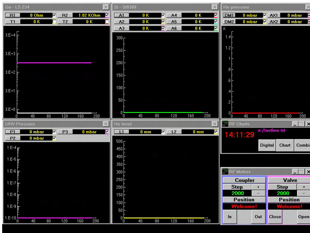
Figura 4-28 – Esempio di una schermata del programma di visualizzazione dati RF_Charts . In basso a sinistra è presente una piccola finestra per il programma che controlla i motori.
