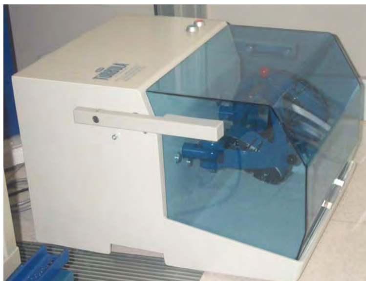
Figura 3-1 – Macchinario per la lucidatura meccanica di una cavità attraverso la tecnica di burattatura.
