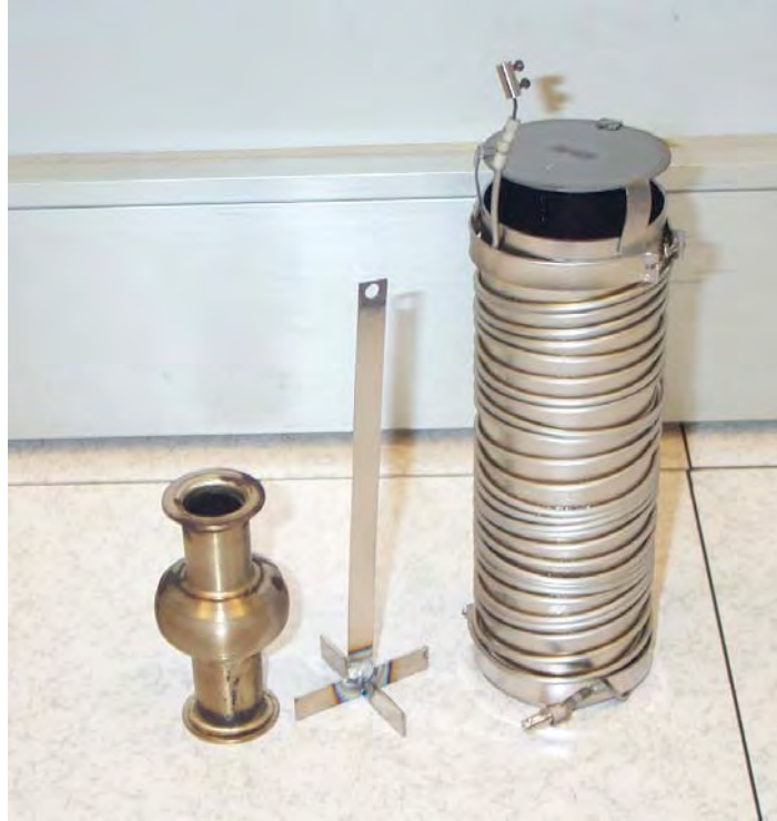
Figura 3-6 – Foto degli elementi costitutivi del forno per il trattamento termico della cavità. A sinistra si trova la cavità in Nb, al centro il supporto per l'ancoraggio in Ti, a destra il tubo di titanio con una serpentina riscaldante in inconel.
