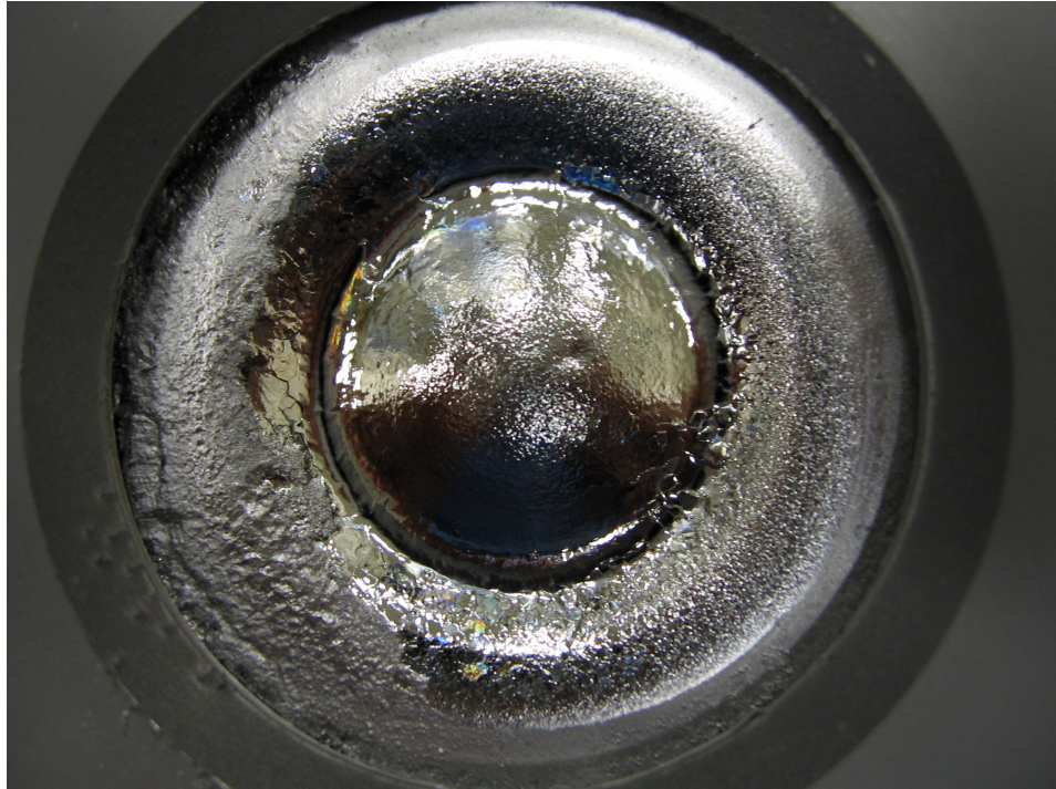
Fig. 4.8. Target in Nb utilizzato per le deposizioni Hollow Cathode Sputtering. È visibile sulla sinistra una parte della superficie interessata da un processo di erosione maggiore.
