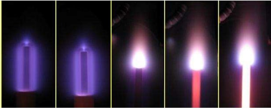
Figura 2.8 Sequenza fotografica dell'innesco di una scarica hollow cathode mediante glow discharge 7 .
