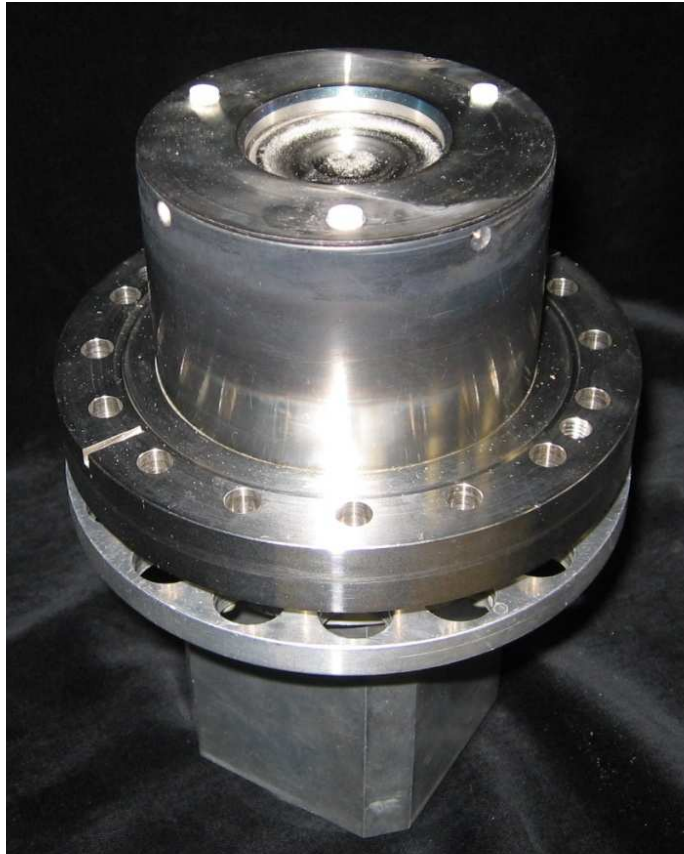
Figura 6.3 Foto del magnetron planare da 2" modificato. Sono ben visibili i 3 isolatori in nitruro di boro che sostengono ed isolano l'hollow cathode
