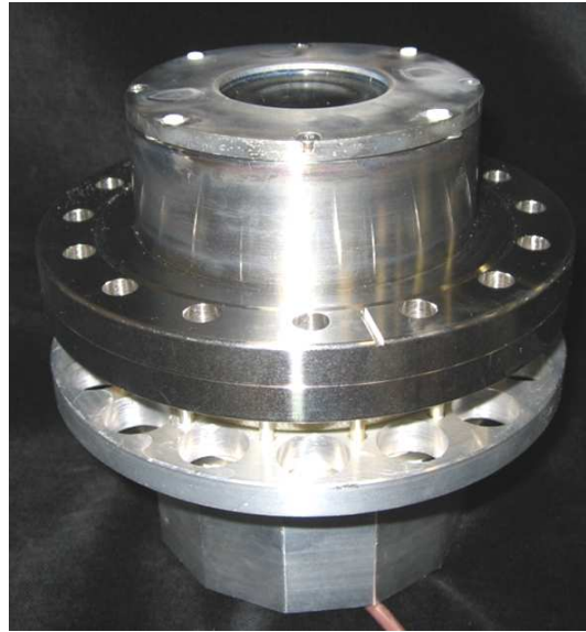
Figura 7.4 Foto del magnetron planare da 2" nuova generazione modificato.
