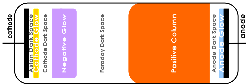
Figura 1.4 Schema della struttura di una scarica a bagliore.
