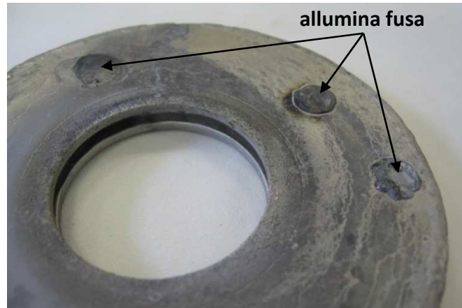
Figura 6.6 Isolatori di allumina fusi e incollati alla superficie dell'hollow cathode.
