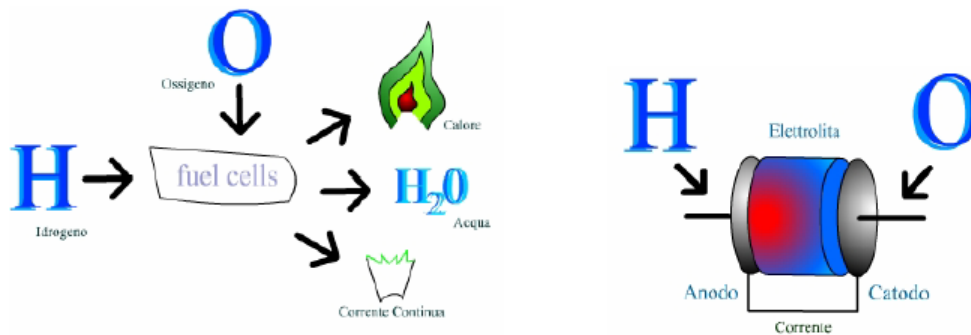
Figura 3. Prodotti e reagenti in una fuel-cell
