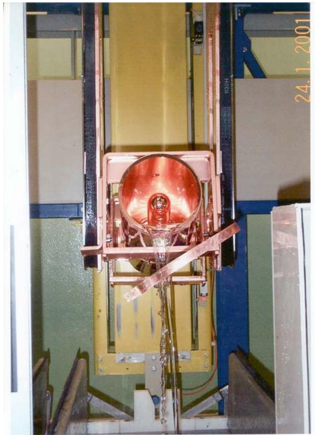
**Fig. 1: Cavità superconduttrice elettrolucidata per l'acceleratore ALPI**
