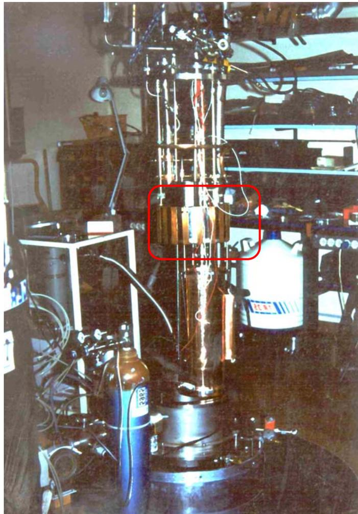
Figura 19: criostato utilizzato per la misura della PBG
