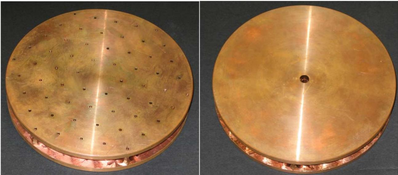
Figura 9: PBG a 6 GHz in rame, piatto superiore con i fori di raffreddamento (sx), piatto inferiore con la *beam port* (dx)
