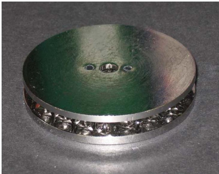
Figura 16: cavità 14 GHz dopo la pulizia chimica
