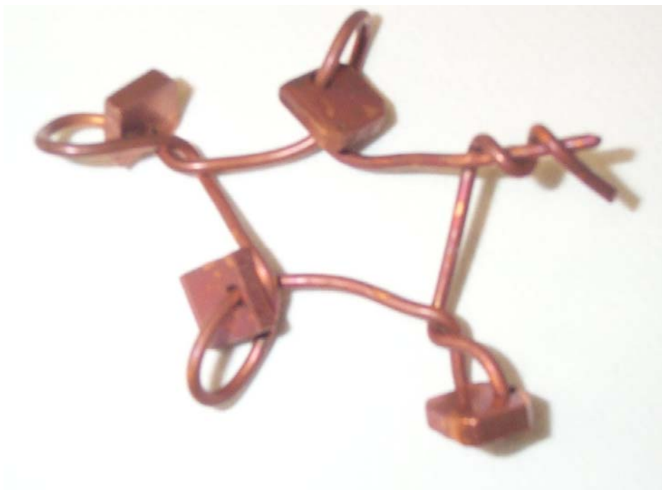
Figura 5.4 Un set di campioni legati fra loro da un telaio di filo di rame. Come si nota, sono messi in condizioni di non collidere fra loro.
