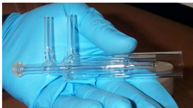
Figura 3.7 La torcia al plasma dell'apparecchiatura da noi utilizzata.
