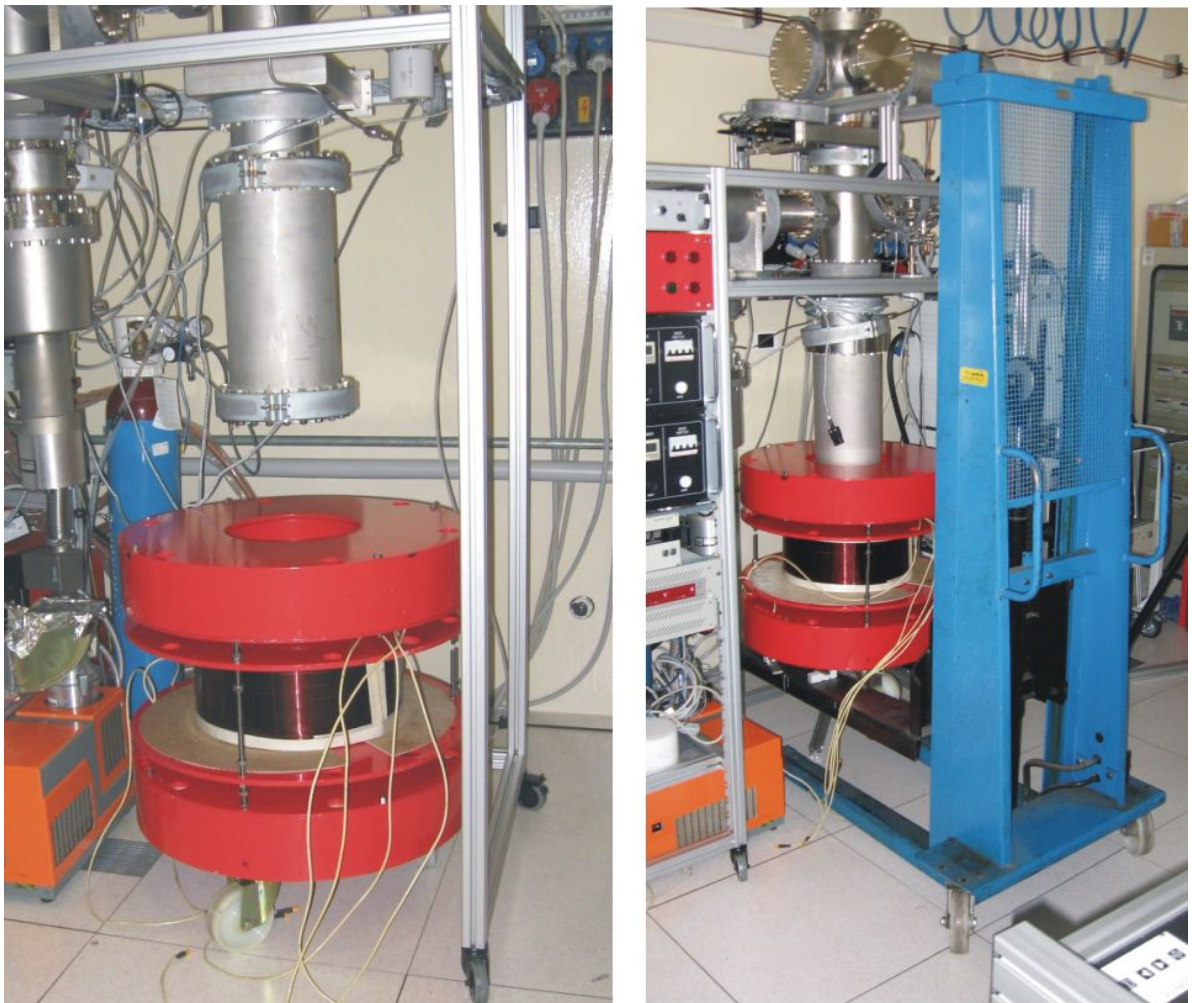
Figura 4.4 Nella figura a sinistra, il sistema di solenoidi assemblato e posizionato sotto la macchina. Si notano le barre filettate che fungono da distanziali regolabili. La schermatura del magnete centrale è stata rimossa per mostrare i dettagli costruttivi. A destra, una fase del sollevamento sei magneti. A destra, una fase del sollevamento del sistema. E' stato necessario mettere in bolla sia la camera che i solenoidi per riuscire a renderli coassiali.
