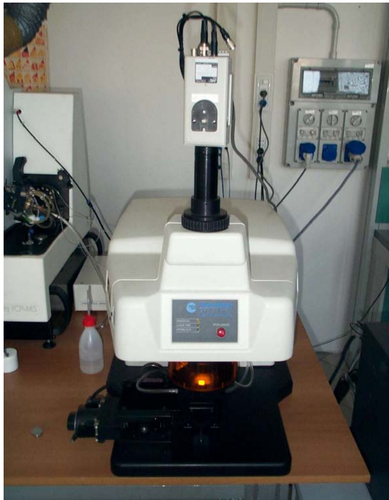
Figura 3.5 L'apparato di ablazione laser presente al CNR-IENI di Padova da noi utilizzato. Si tratta di un'unità dotata di laser Nd:YAG, che lavora a una lunghezza d'onda di 213 nm che sviluppa una potenza di circa 9J/cm 2 .
