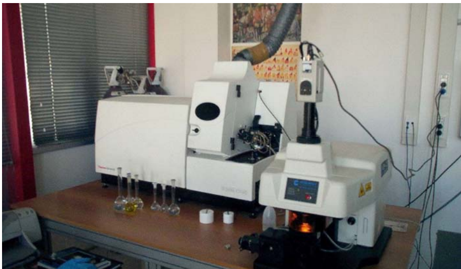
Figura 3.1 La postazione ICPMS. Si nota sulla destra il modulo per l'ablazione laser con il relativo sistema di acquisizione di immagini. Il sistema di pompaggio (turbo e rotativa) è sotto il tavolo, assieme al gruppo di alimentazione del laser. Il tubo grigio è lo scarico della torcia.
