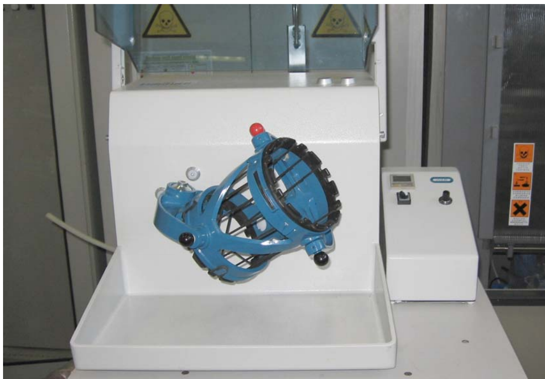
Figura 5.31 Il buratto a movimentazione giroscopica
