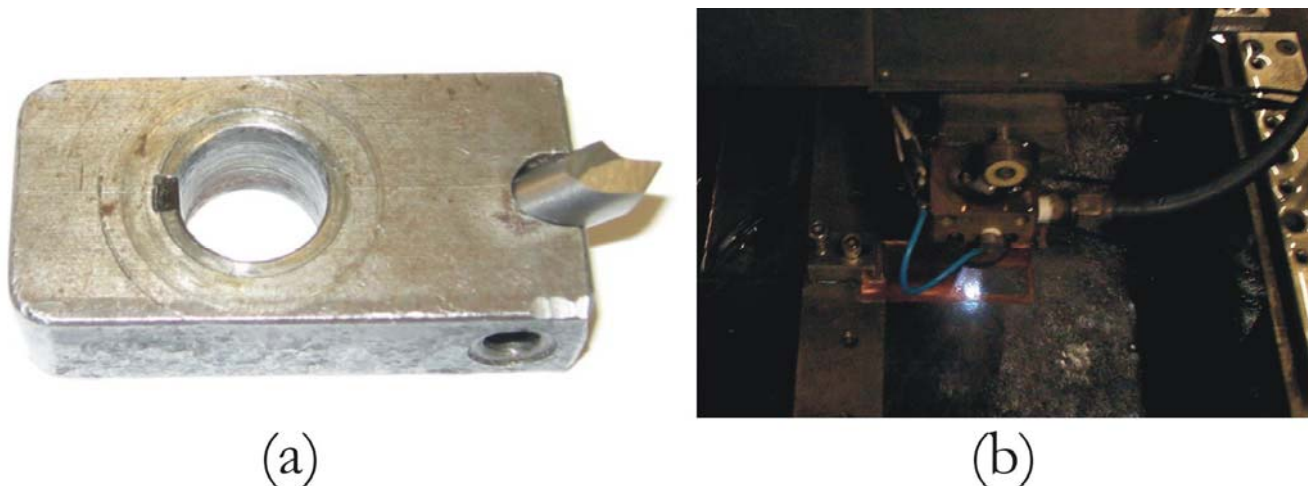
Figura 5.5 (a) La “mosca”, l’utensile usato per lucidare la superficie superiore dei campioni. (b) Il processo di taglio all’elettroerosione dei campioni in rame.
