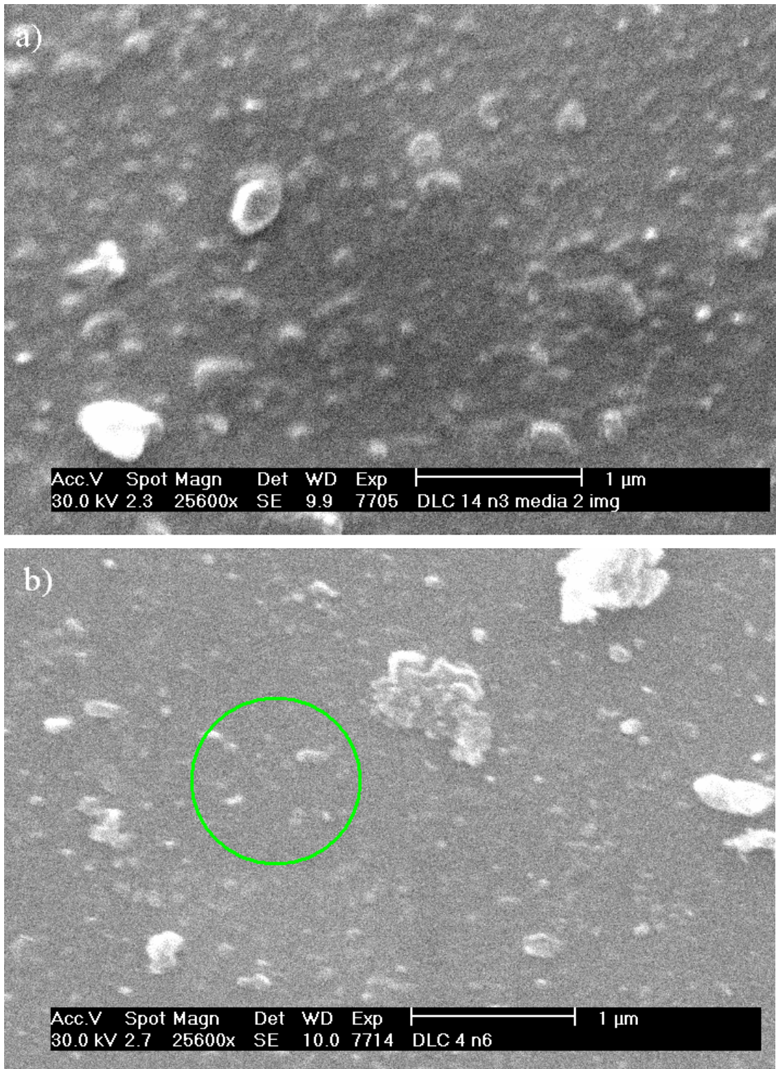
Fig. 4.7. a) Film depositato per CVA in posizione tre. b) Film depositato per CVA in posizione sei, è indicata in verde anche la dimensione dello spot del laser, è chiaro come sia facile che l'area del film selezionata per l'analisi Raman possa comprendere le macroparticelle più piccole non visibili al microscopio ottico.
