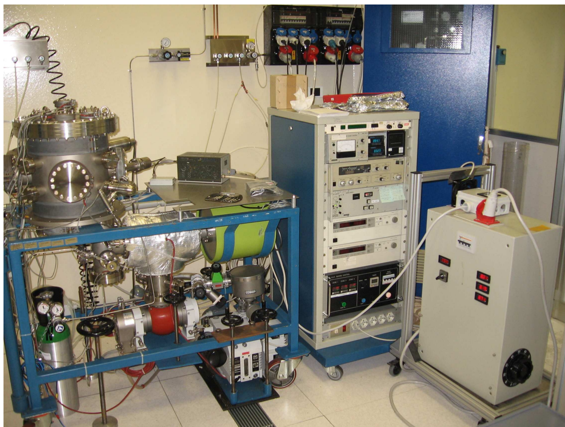
Figura 4.2: Il sistema impiegato nella produzione dei film di V_3Si . Nel rack a destra sono raggruppati i lettori di pressione, di temperatura e del gas analyzer, il controller della pompa turbomolecolare, i generatori DC ed il sistema di baking. Sul carrello, il sistema di alimentazione trifase delle lampade.
