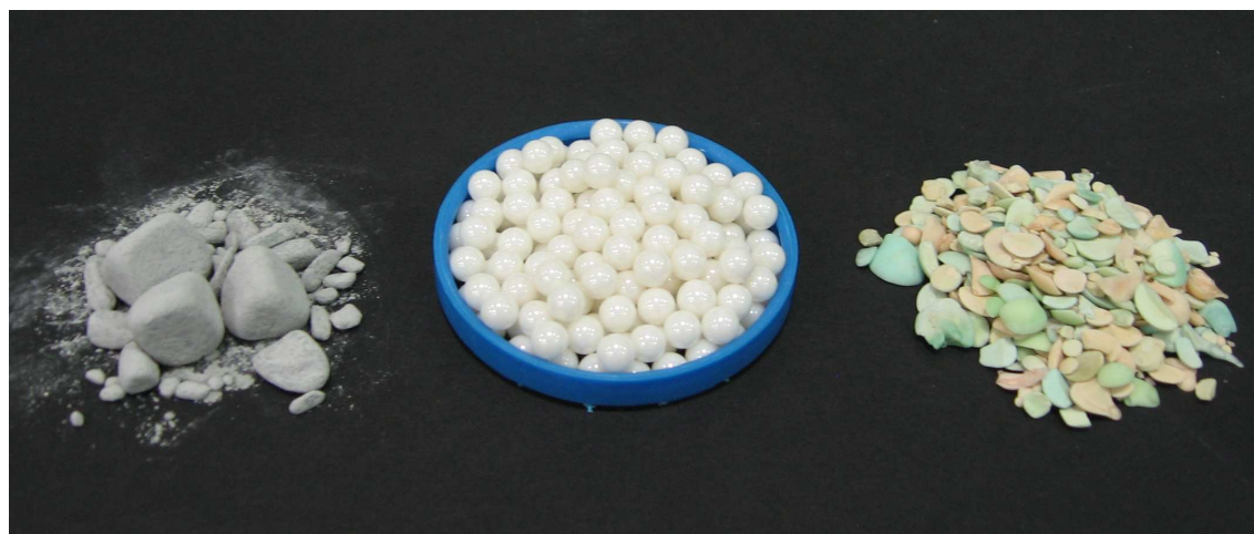
Figura 3.6: I diversi media impiegati nel trattamento meccanico delle cavità: a sinistra il SiC, in centro la ZrO_2 , a destra l' Al_2O_3 + SiO_2 .
