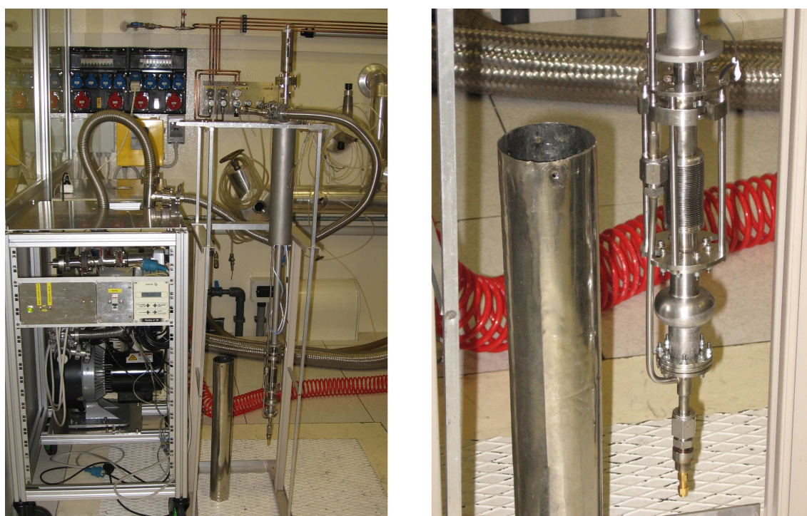
Figura 5.44: Il sistema di pompaggio per le misure in radiofrequenza, con lo schermo magnetico. A destra, particolare dell'assemblaggio della cavità.
