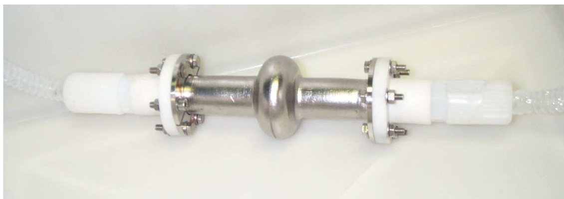
Figura 3.7: Il sistema di flange per il trattamento chimico mediante pompaggio pulsato delle cavità 6 GHz. Durante il processo la cavità è mantenuta in posizione verticale.
