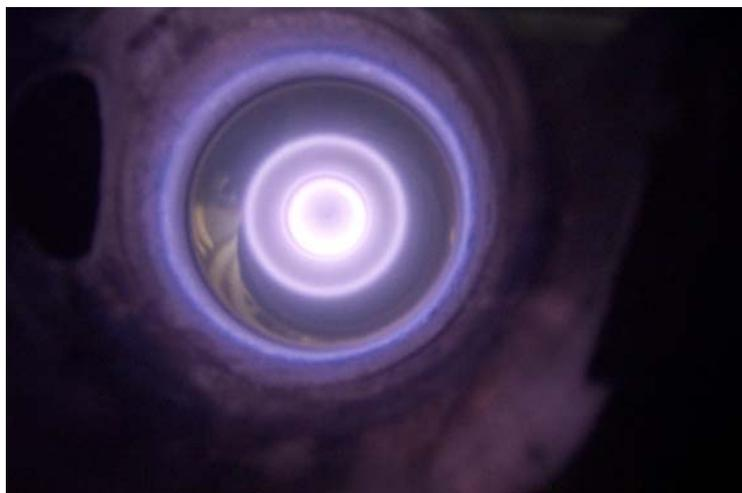
*Fig.39 e 40 Immagini del fascio estratto dalla sorgente IG2. Nell'immagine inferiore il fascio viene focalizzato da un campo magnetico assiale pari a 500 G.*
