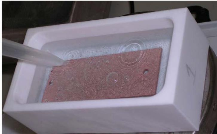
Fig. 20 Attacco acido dei campioni mediante acido nitrico
