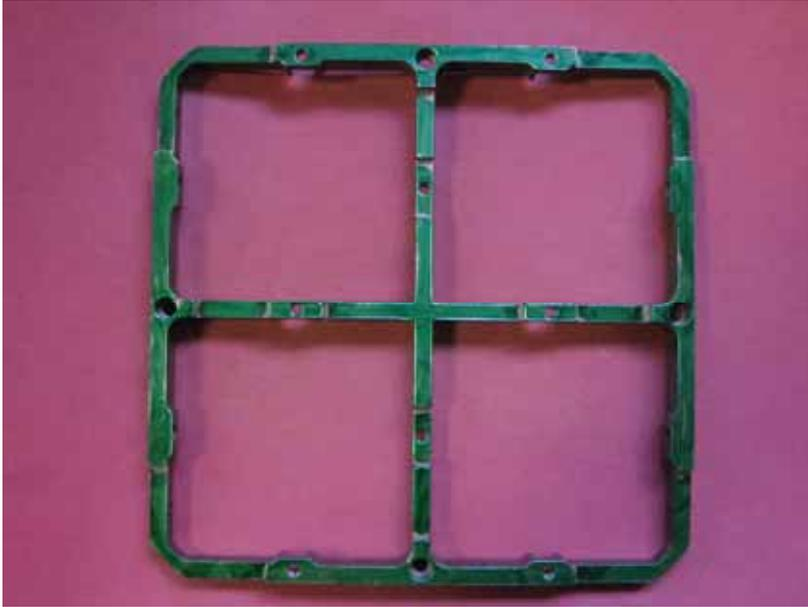
**Figura 2.9.** Il frame di CUORICINO usato per le prove e del trattamento di buratto secco. Il colore verde ci permette di vedere immediatamente l'effetto del trattamento.
