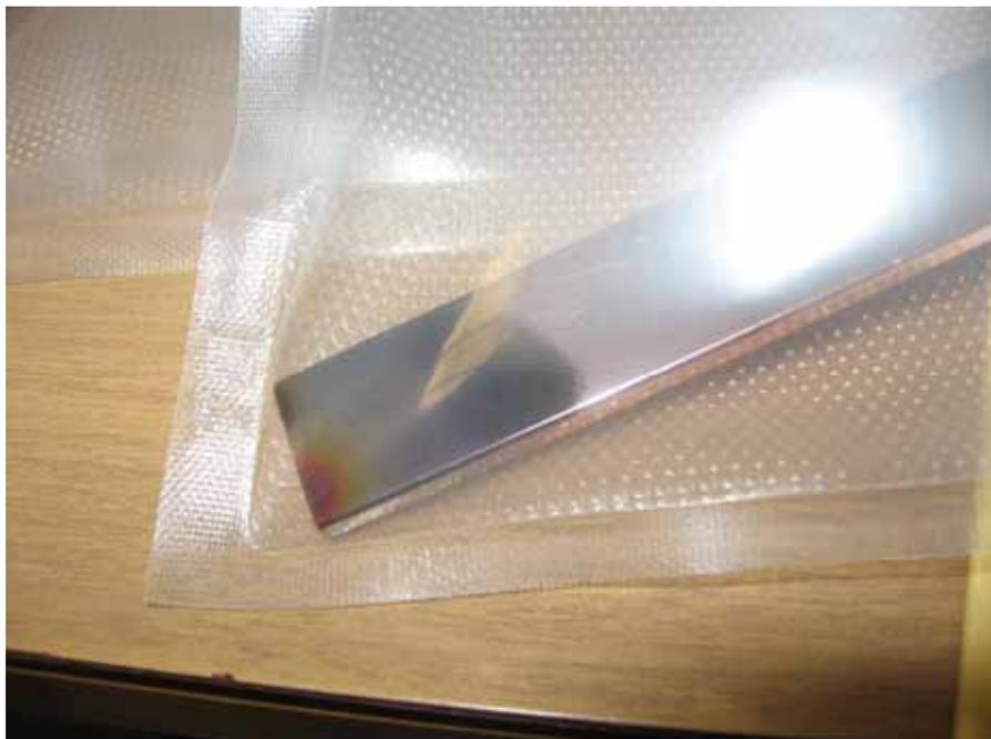
**Figura 5.12.** Dettaglio di una barra, già sigillata all'interno del sacchetto di conservazione in atmosfera di  $N_2$ , che presenta una notevole chiazza nera generatasi nel corso del processo di plasma *etching*.
