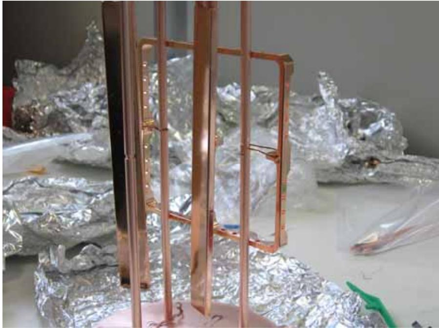
**Figura 4.5.** Dettaglio del frame di CUORE che evidenzia il modo di fissaggio dello stesso sul porta campione.
