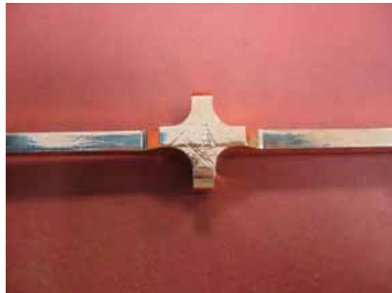
**Figura 3.8.** Dettaglio di un frame elettropulito che evidenzia la superficie estremamente pulita e lucida ottenuta.
