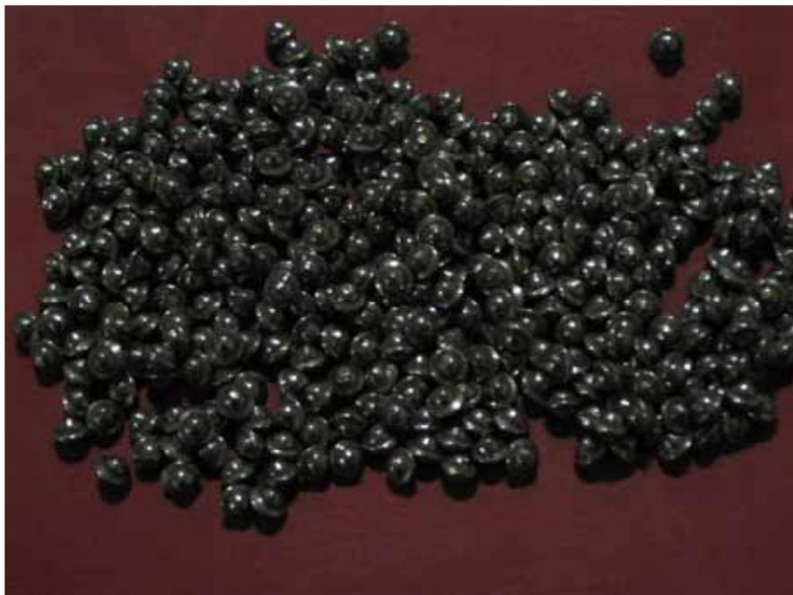
**Figura 2.1.** Un'immagine del SAT03/05, i satelliti utilizzati con il sale grosso. La sigla 03/05 indica le dimensioni in mm degli stessi satelliti.
