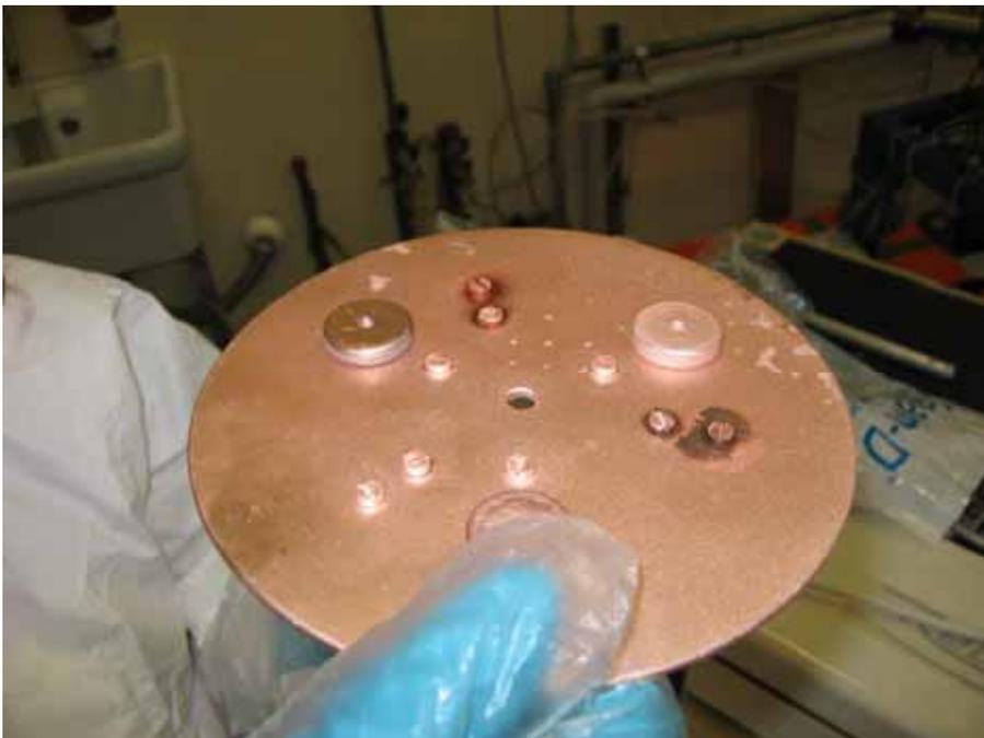
**Figura 5.11.** Dettaglio del piatto superiore del porta campione che evidenzia i fori che sono stati fatti sul piatto stesso e attraverso i quali è stato possibile attaccare, mediante viti M3, sia le barre che le colonne.
