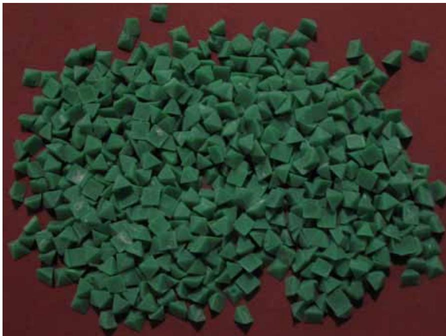
**Figura 2.2.** Immagine del RKG 6PQ, piramidi verdi di allumina in una matrice di resina epossidica. La sigla RKG indica la qualità del media, il 6 le sue dimensioni e PQ la forma.
