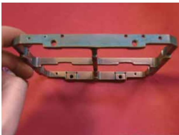
**Figura 2.10.** Frame di CUORICINO ottenuto con la turbula e utilizzando il doppio trattamento: 4 ore satelliti/sale e 2 ore coni in umido.
