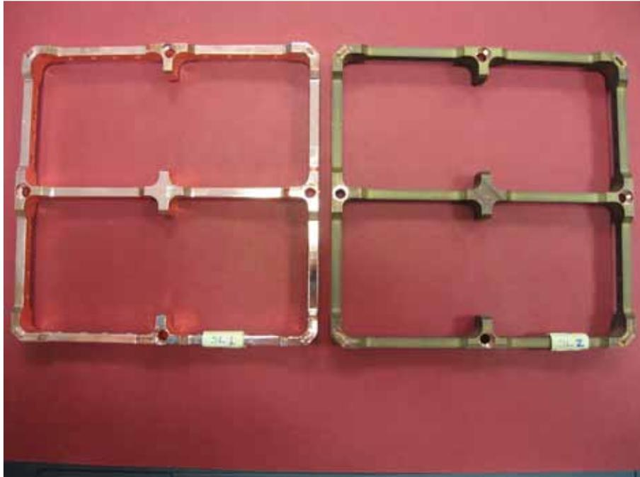
**Figura 3.7.** Confronto tra un frame elettropulito ed uno a cui non è stato applicato alcun trattamento di pulizia.
