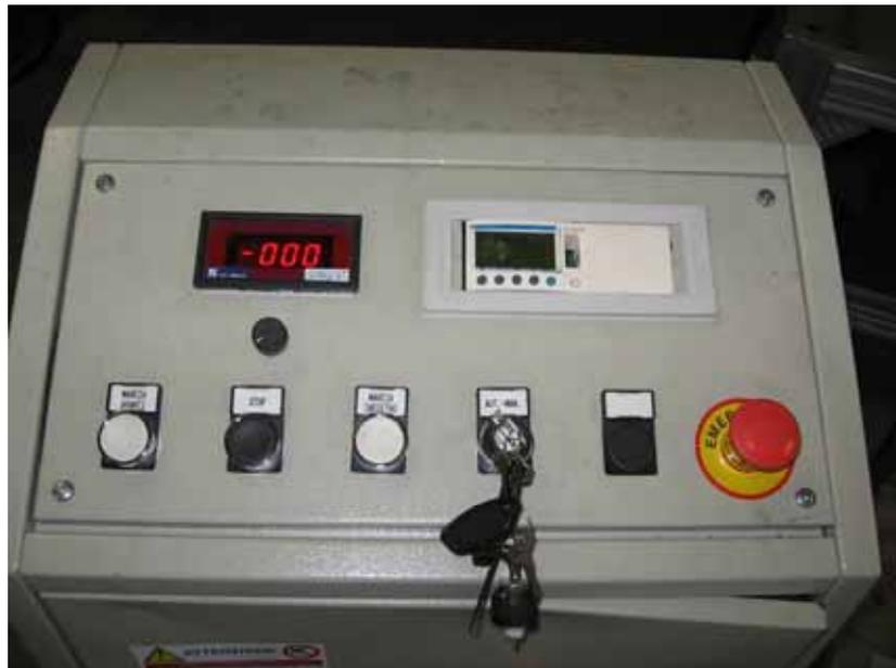
**Figura 2.5.** Un'immagine del pannello di controllo. Esso permette di regolare la velocità del buratto, la direzione di rotazione e la fine del processo.
