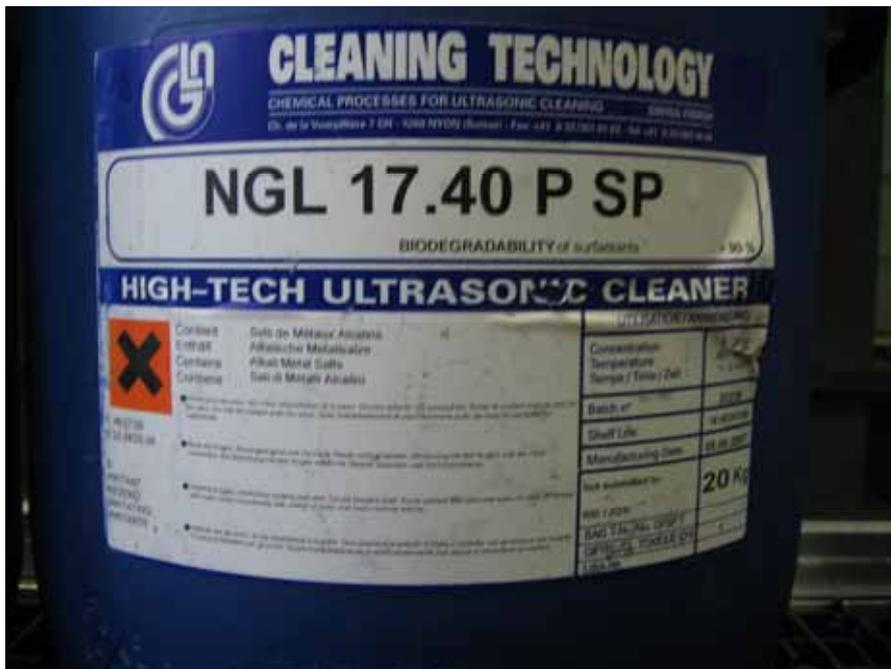
**Figura 1.1.** L'etichetta del NGL 1740 P SP, uno dei saponi utilizzati per la pulizia dei pezzi in Cu di CUORE.
