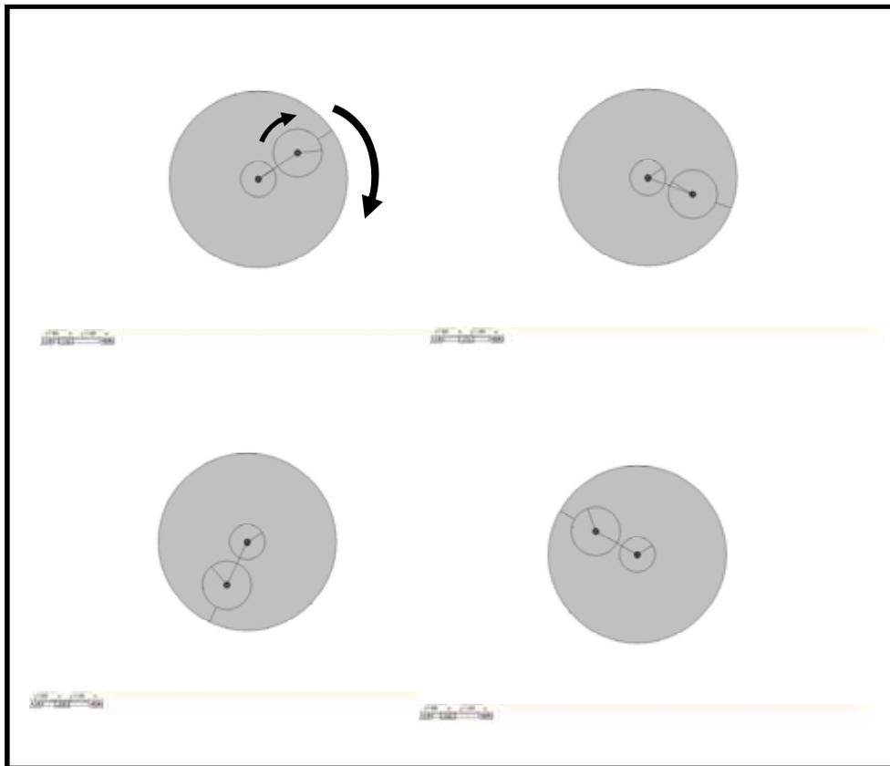
**Figura 2.5.** Schema di funzionamento del buratto utilizzato per pulire i campioni di CUORE. Le 4 immagini rappresentano la rotazione della struttura rotante, che ha lo stesso verso di rotazione del cestello.
