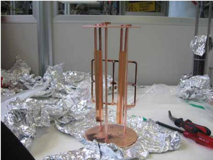
**Figura 5.4.** Frame di CUORE appeso al portacampione per essere posto in camera da vuoto.
