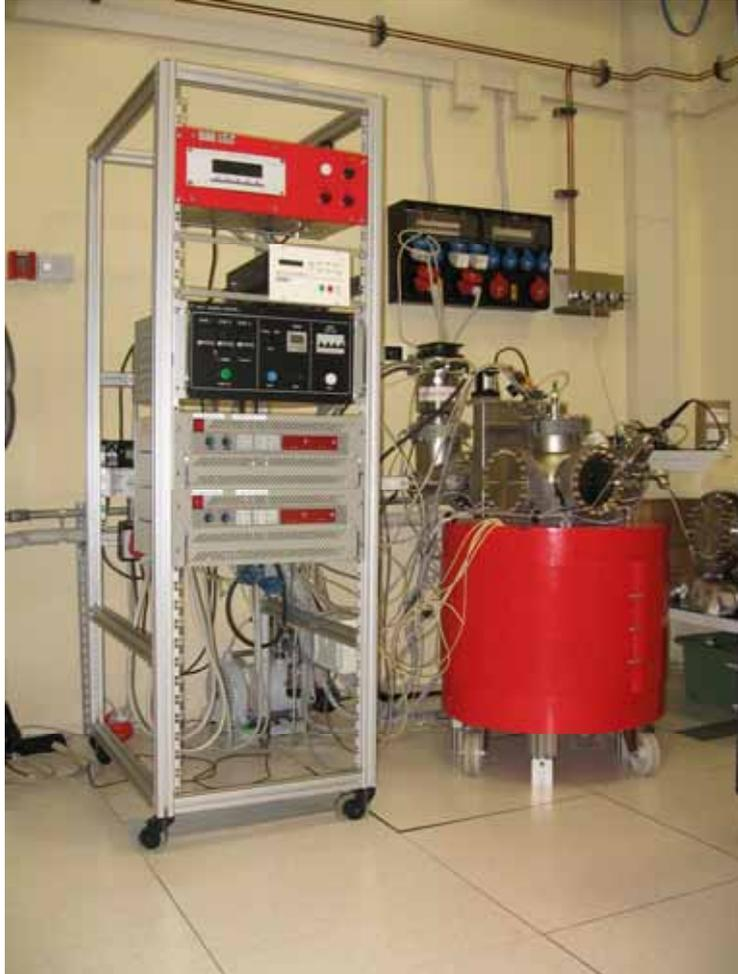
**Figura 5.1.** Sistema da vuoto utilizzato per trattare mediante plasma i campioni di CUORE. Il sistema è composta dalle bobine magnetiche (in rosso), dalla camera di processo e dai dispositivi per ottenere il vuoto.
