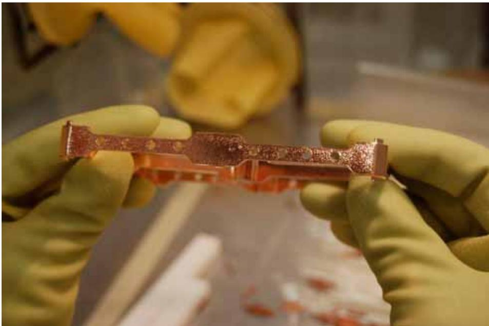
**Figura 3.5.** Dettaglio dell'effetto "a buccia d'arancia" osservato sul lato inferiore del frame elettropulito. Tale effetto è dovuto al ristagno delle bollicine di  $O_2$  sulla superficie.
