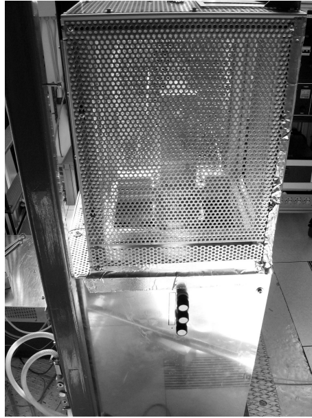
Figura 9.10: Foto della gabbia di Faraday ultimata
