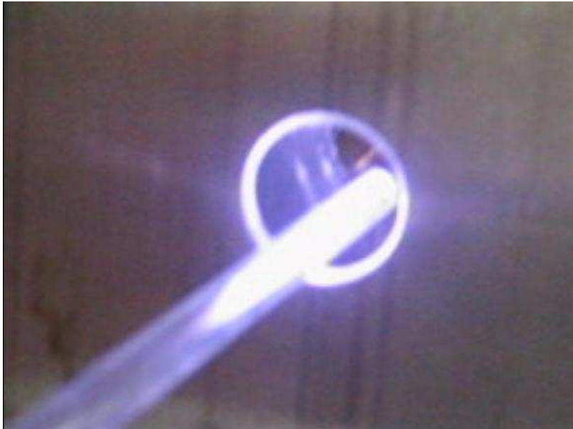
Figura 8.8: Foto del plasma creatosi alla fine del nozzle e prolungato col tubo di quarzo successivo
