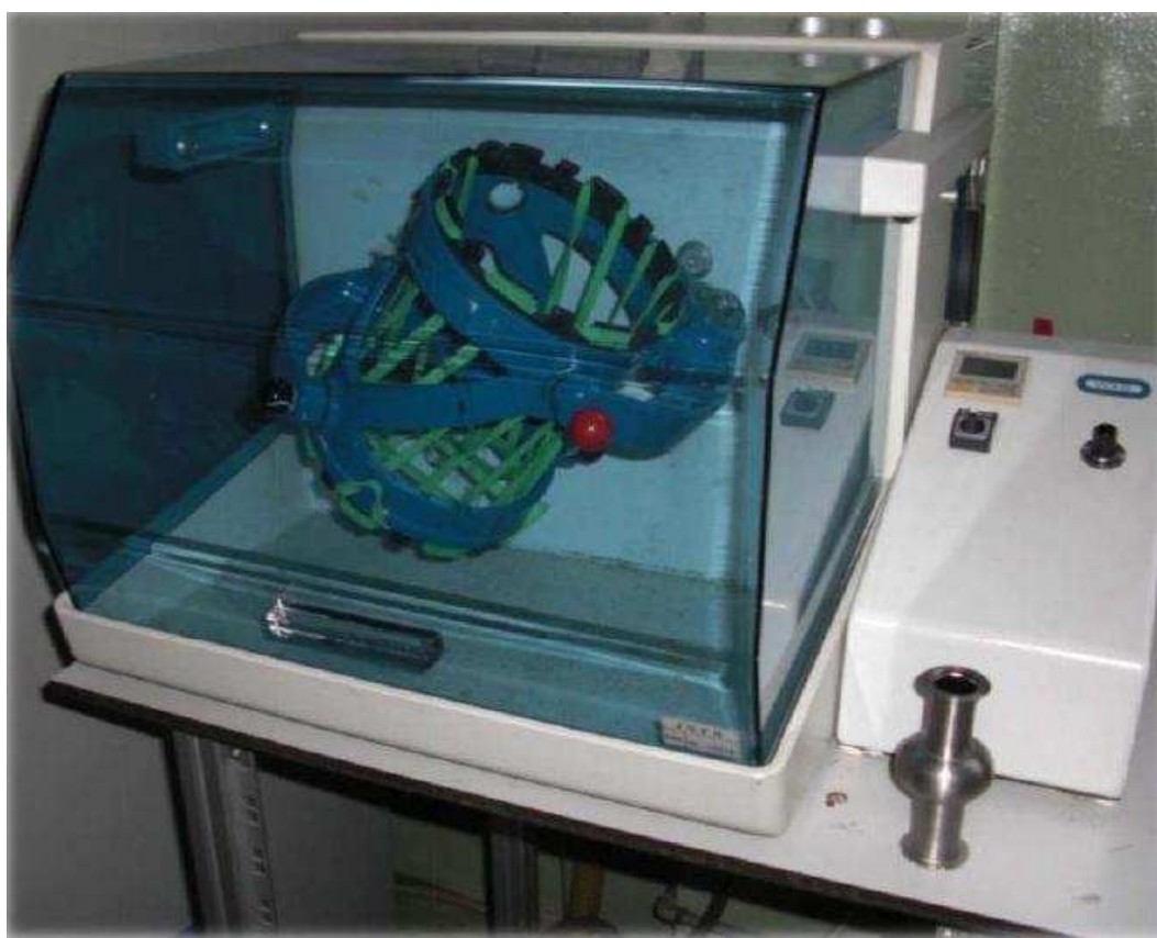
Figura 10.1: Foto del tumbler Turbula utilizzato per la fase di burattatura di tutti i campioni trattati
