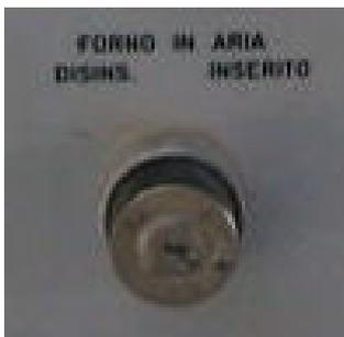
**forno in aria:** (solo con chiavetta) permette di accendere il forno anche non in vuoto
