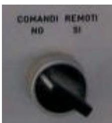
**comandi remoti**: da il consenso per poter controllare i comandi del forno da un pannello remoto di controllo manuale
