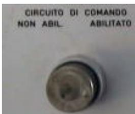
**circuito di comando** (solo con chiavetta): abilita o meno il comando manuale attraverso il pannello di controllo
