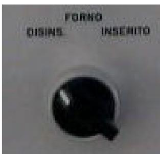
**Forno inserito /disinserito:** da tensione al forno e consente di dare potenza ai resistori
