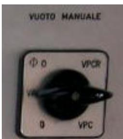
**vuoto manuale:** selettore che permette di azionare le valvole di controllo dell'alto vuoto e prevuoto:
