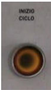
**inizio ciclo:** da avvio al ciclo di trattamento termico scaricato nel PLC di controllo
