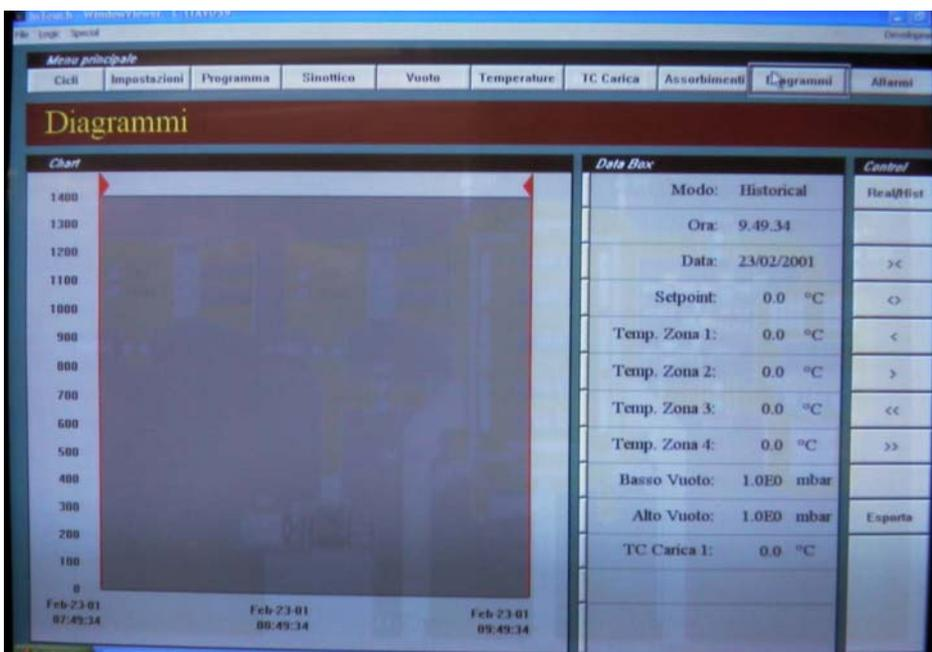
Viene visualizzato il diagrammi relativo al ciclo termico in esecuzione, riassumendo i parametri più significativi (vuoto, Temp. Carica, Temp forno...)
