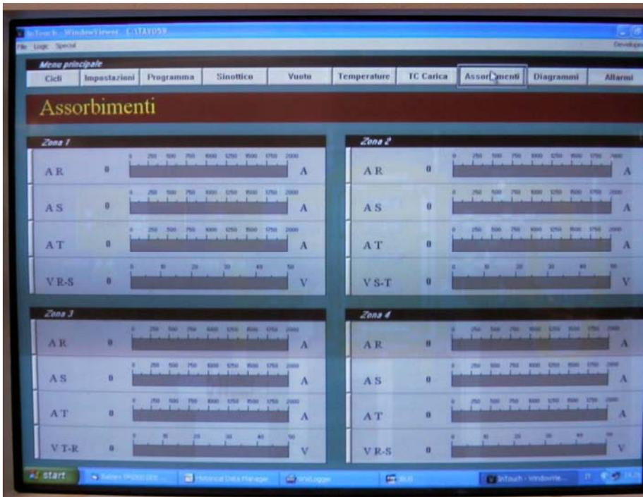
Vengono visualizzati gli assorbimenti di corrente e le tensioni relative alle quattro zone per ognuna delle tre fasi di corrente.
