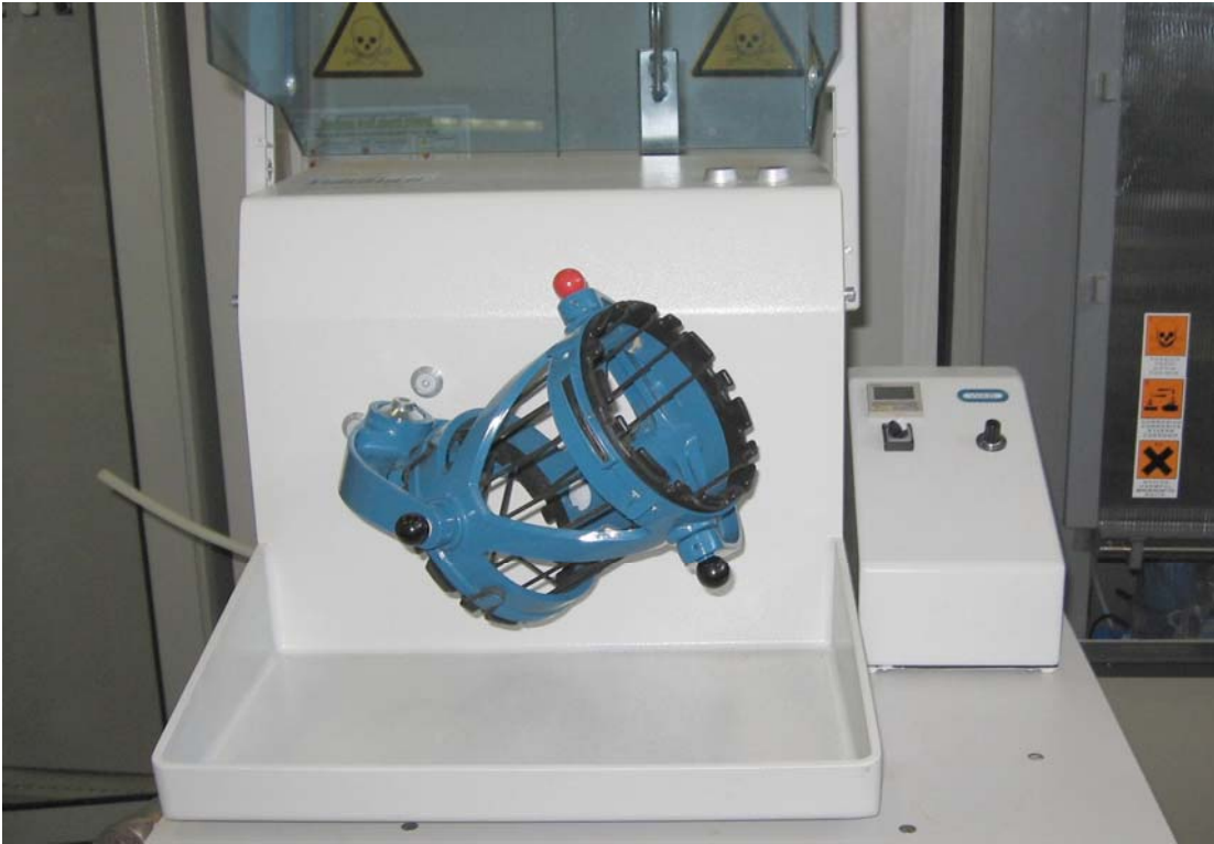
Figura 5.31 Il buratto a movimentazione giroscopica
