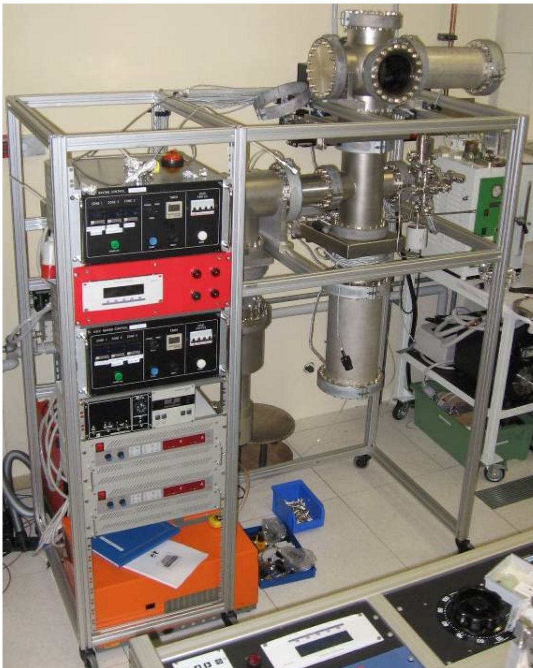
Figura 3.8 Il sistema denominato ICD così come si presentava all'inizio del lavoro di tesi. Si noti l'altezza da terra della camera di processo, tale da permettere il posizionamento e successivo sollevamento delle bobine magnetiche con un muletto pneumatico manuale. Appare inoltre evidente la scomodità di operazione e introduzione dei campioni. Si tenga presente che il solo telaio è alto 2 metri.
