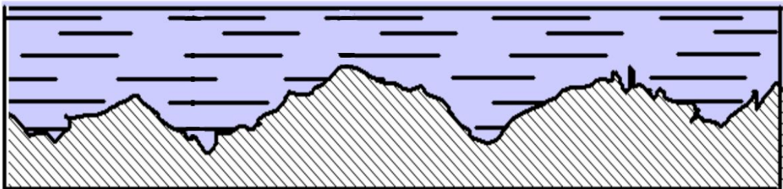
Figura 1.1 Schema della microrugosità di una superficie metallica immersa nel bagno elettrolitico. [4]
