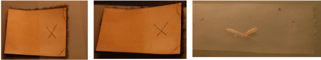
Figura 26: esempi della variante dello “scotch tape test” chiamata “X cut test”; a sinistra un lembo di pelle ricoperta di oro su cui è stata incisa una X e applicato il nastro adesivo, al centro la foto del campione dopo la rimozione del nastro adesivo riportato in figura a destra.
