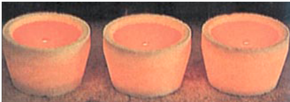
Figura 15: cospelle incandescenti estratte dal forno nel corso di un’analisi per coppellazione in cui sono visibili le palline metalliche fuse, costituite dagli elementi preziosi contenuti all’interno della lega. 6
