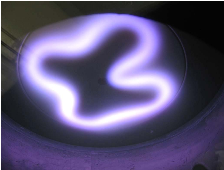
Figura 3-3: Immagine del plasma in atmosfera reattiva di azoto con target di titanio ( p_{TOT}=8*10^{-3} ). Si noti il colore bianco del plasma
