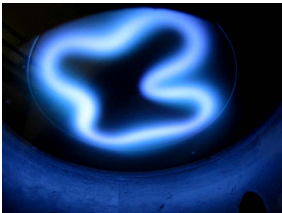
Figura 3-2: Immagine del plasma in atmosfera di argon ( p=5 \cdot 10^{-3} ) con target di titanio. Si noti il colore azzurro del plasma
