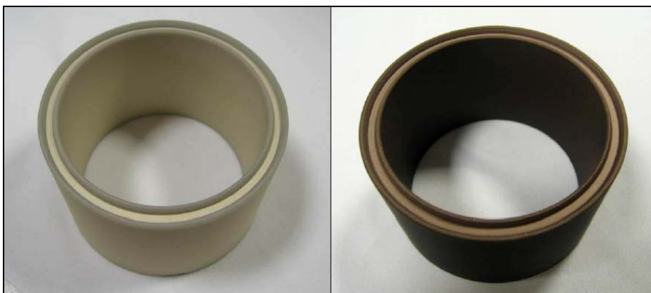
Figura 3-8: Cilindri di allumina depositati con 10nm (sx) e 800 nm (dx) di TiN
