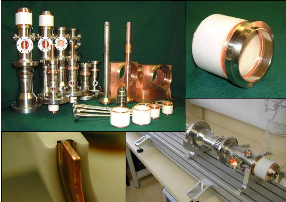
Figura 1-1: Esempi di finestre per radiofrequenza in allumina di fabbricazione industriale 2 . Le finestre illustrate sono integrate in un accoppiatore di potenza di tipo TTF3 per cavità superconduttrici.
