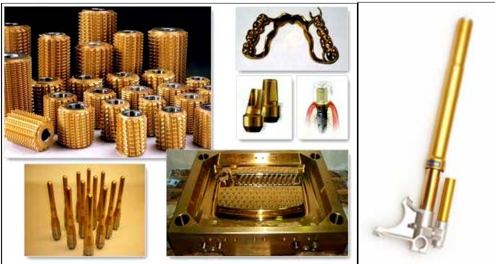
Figura 2-16: Esempi di applicazione dei rivestimenti di TiN: creatori, ugelli, utensili da taglio e stampi 15 , forcelle di moto da competizione.
