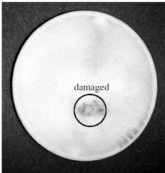
Figura 1-2: Finestra di \text{Al}_2\text{O}_3 danneggiata da un fenomeno localizzato di multipacting originato in corrispondenza di un difetto superficiale 1 .
