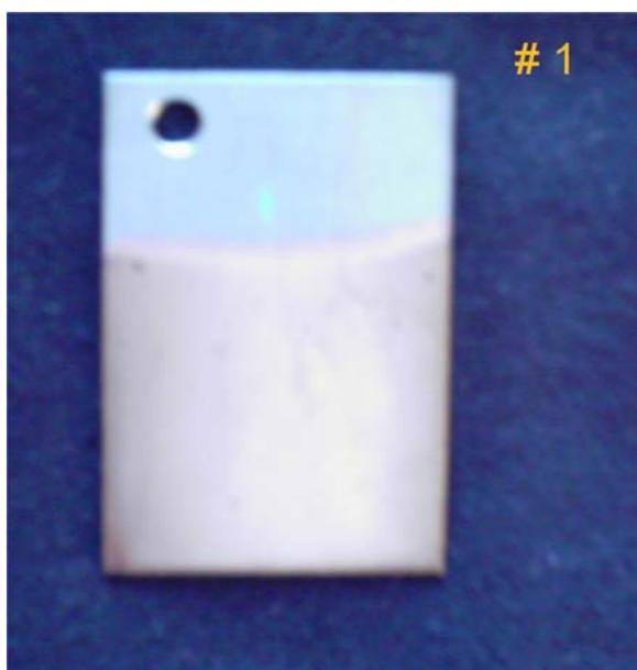
**Figura 4.4** Fotografia del campione di acciaio con il film elettrodepositato utilizzando da soluzione notata come soluzione #1 contenente acido citrico.
