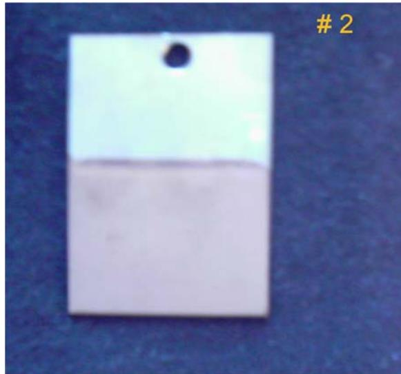
**Figura 4.5** Fotografia del campione dopo el'elettrodeposizione di rame con la soluzione #2 contenente EDTA.
