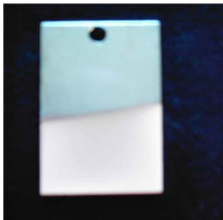
Figura 4.9 Fotografia del film di rame elettrodepositato con la soluzione del brevetto US 2 250 556.
