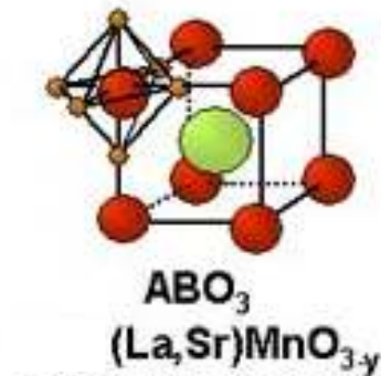
Figura 13 – Schema di una specie tipo \text{ABO}_3 a struttura cristallina perovskitica.
