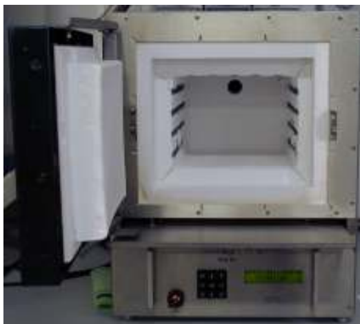
Figura 12 - Muffola (VMK 80 della Linn High Therm GmbH) per trattamenti termici a temperature elevate.
