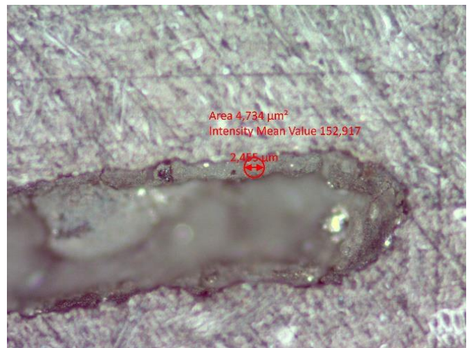
Fig. 4.14 - Sale argentato e spessore di argento visto al microscopio
