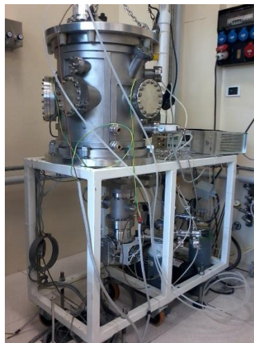
Fig. 4.1 – Sistema da vuoto utilizzato
