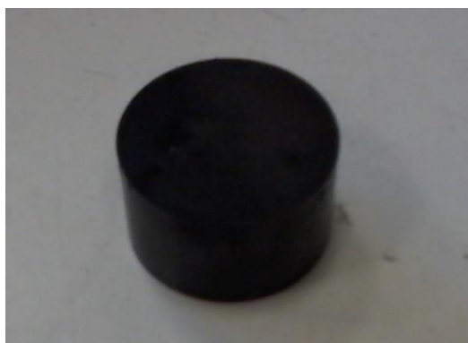
Fig. 3.3 – Provino dopo l'inglobamento
