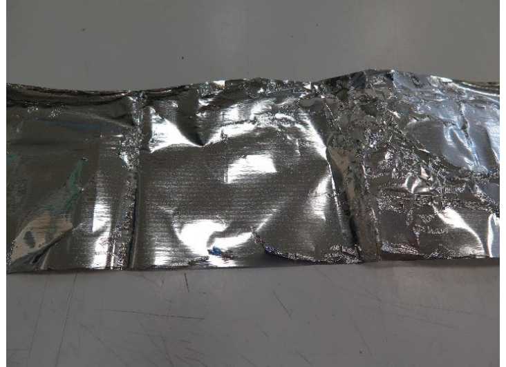
Fig. 4.20 - Carta alimentare prima e dopo la deposizione di argento
