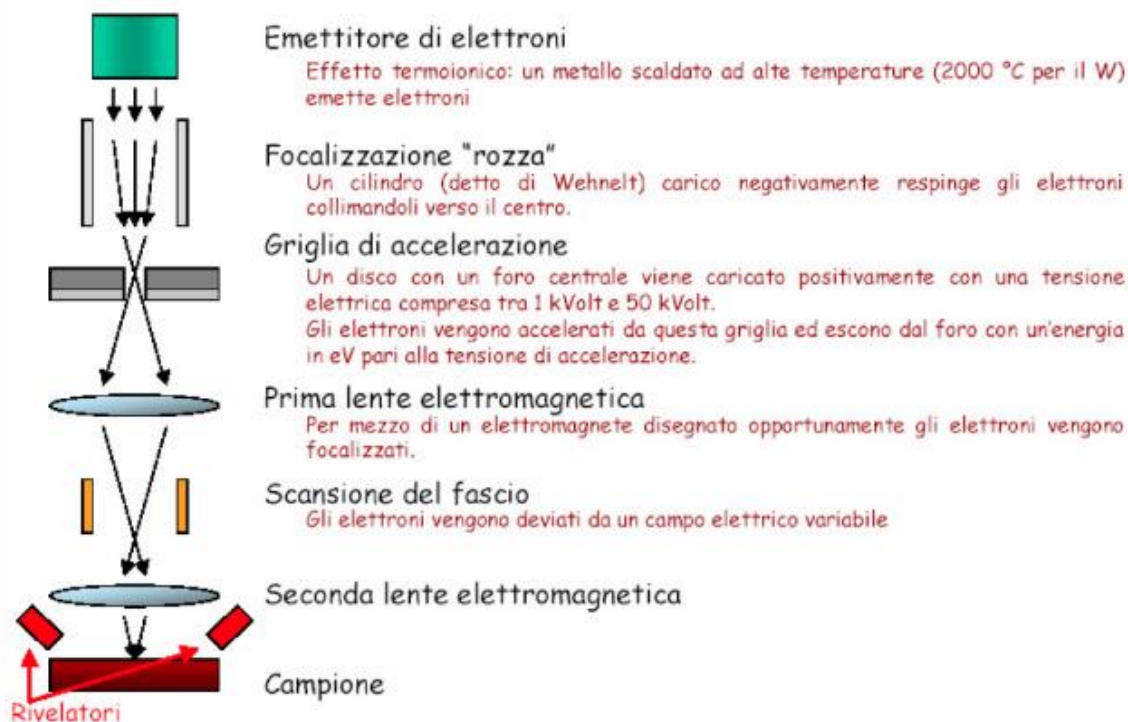
Fig. 3.8 – Il funzionamento del SEM
