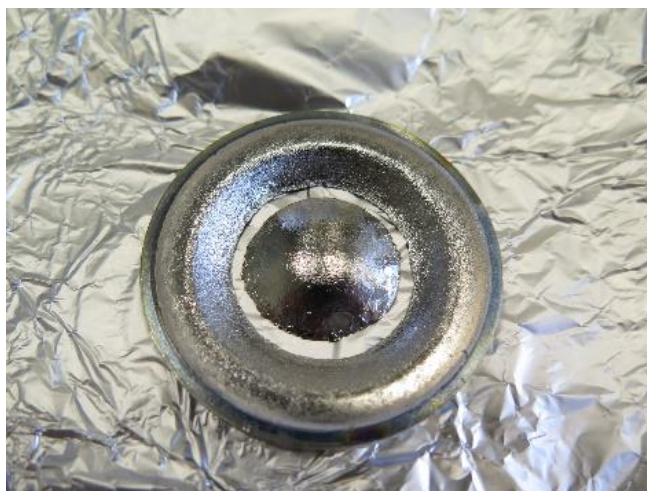
Fig. 2.12 – Target d'argento eroso
