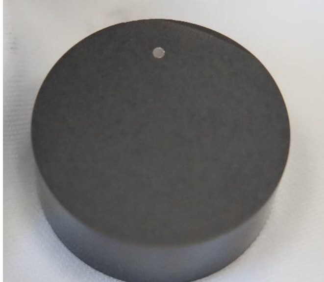
Fig. 3.5 – Provino dopo la lappatura
