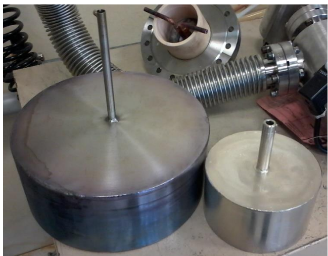
Fig. 4.7 – Il sistema visto dall'esterno e i due portacampioni usati
