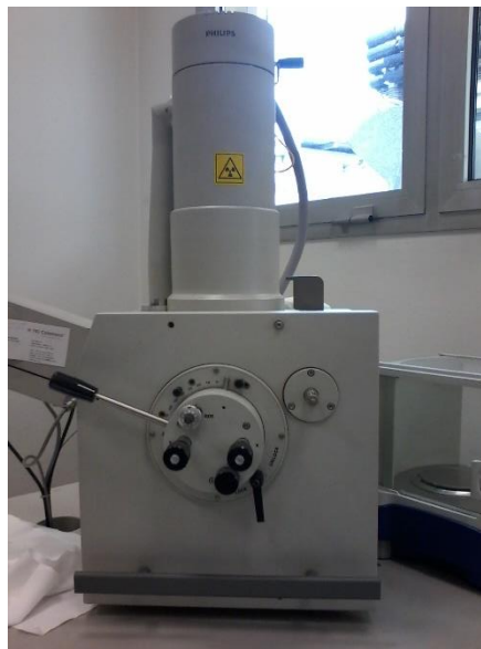
Fig. 3.7 – Il SEM Philips FEI XL 30
