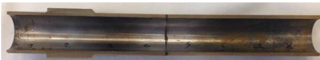
Figura 3.22 Provetta dopo etching chimico ed analizzata tramite SEM
