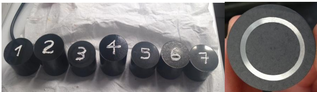
Figura 4.10 Parti della provetta inglobate e trattate chimicamente
