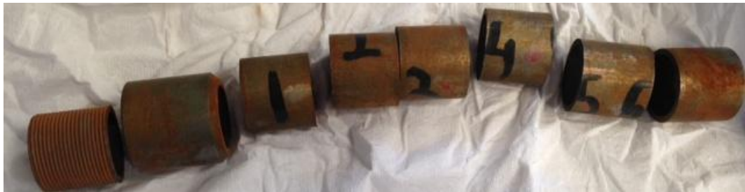
Figura 4.9 Dettaglio della provetta tagliata tramite elettroerosione
