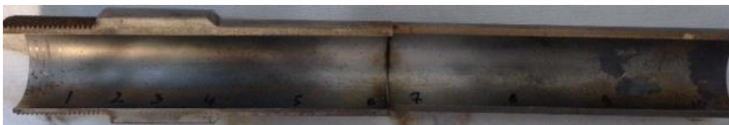
Figura 3.5 Provetta dopo etching chimico ed analizzata tramite SEM
