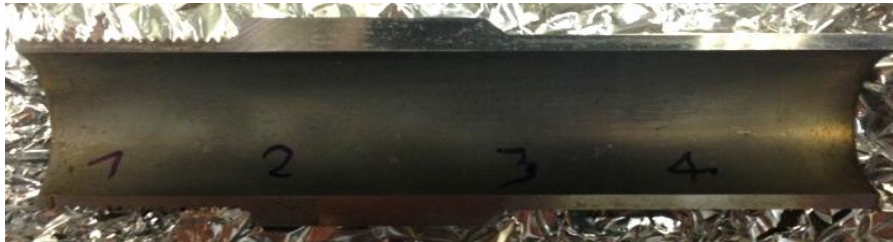
Figura 3.18 Parte di provetta lappata ed analizzata tramite SEM
