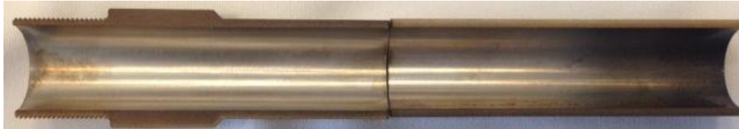
Figura 4.4 Provetta analizzata dopo i test, con substrato in DC
