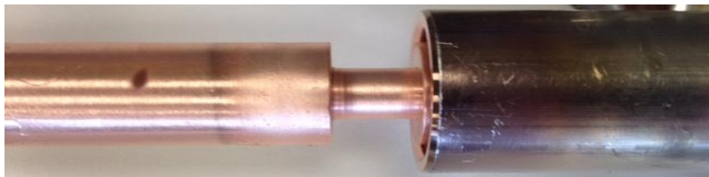
Figura 3.10 Erosione del catodo nelle zone del magnete scoperto e del target
