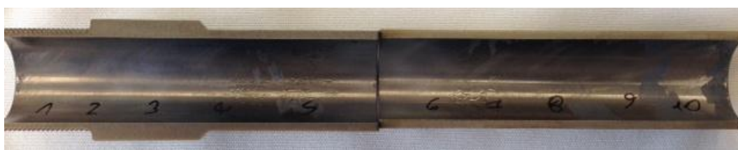
Figura 3.25 Provetta numerata ed analizzata tramite SEM
