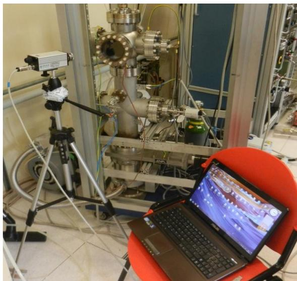
**Figura 6.6** Strumentazione utilizzata per monitorare la temperatura del filamento in camera
