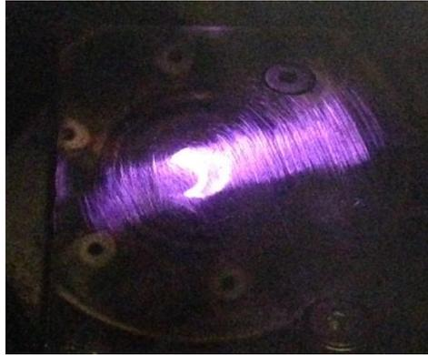
**Figura 5.58** Fotografia del plasma di Argon ed Azoto durante il processo di sputtering visto attraverso oblò e specchio
