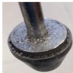
**Figura 5.35** Catodo, wing inferiore e isolatore dopo la deposizione
