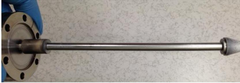
**Figura 5.41** Nuovo catodo(diametro 8 mm) e wings in acciaio
