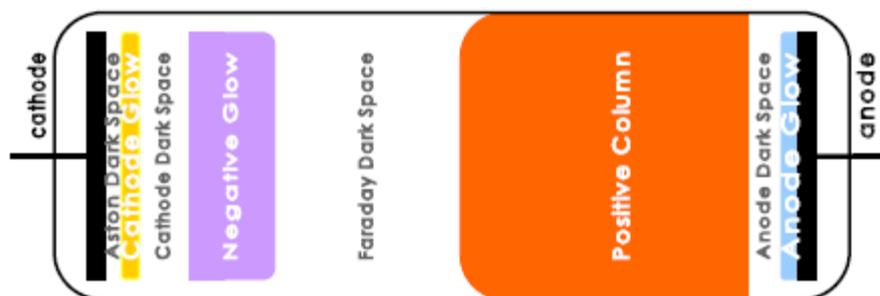
**Figura 2.5** Schema strutturale di una scarica a bagliore
