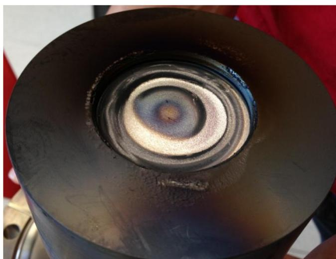
**Figura 6.23** *Erosione del target planare non uniforme dopo l'utilizzo*
