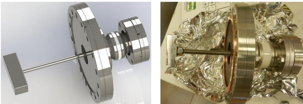
**Figura 6.9** *Rendering 3D e fotografia relativa al nuovo Anodo regolabile tramite asta filettata*
