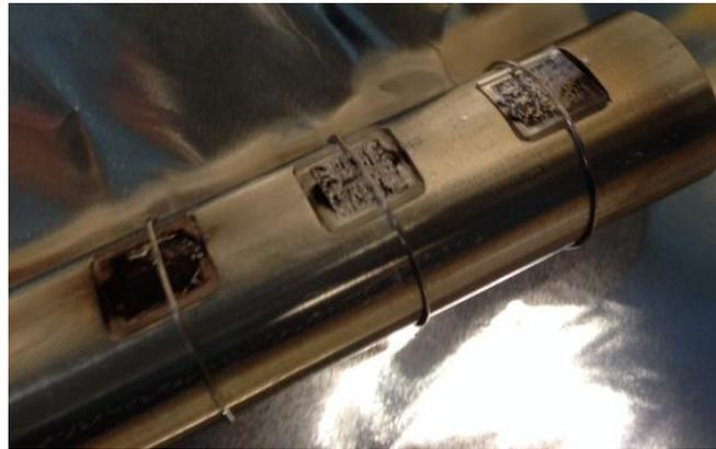
**Figura 5.43** Quarzi completamente delaminati dopo il processo
