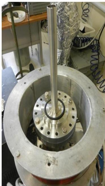
**Figura 4.7** Fotografia del substrato di acciaio inserito per la deposizione
