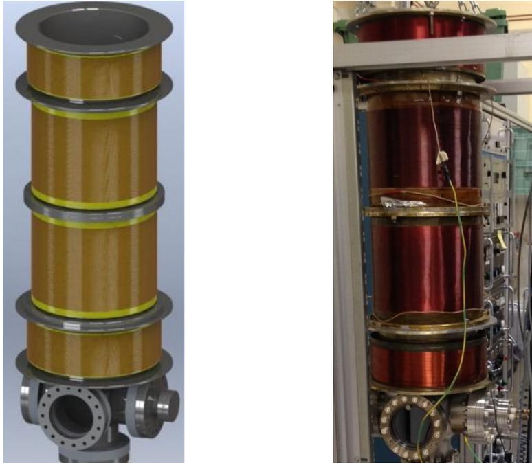
**Figura 5.19** *Rendering 3D e fotografia relative alle 4 bobine collegate in serie*
