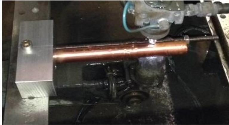
**Figura 5.28** *Lavorazione di elettroerosione sul tubo di rame depositato*
