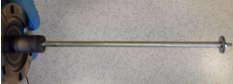
**Figura 5.30** Nuovo catodo con asta in Niobio da 150 mm e wings da 15 mm di diametro
