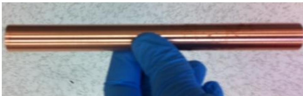
**Figura 5.27** Tubo di rame utilizzato come substrato
