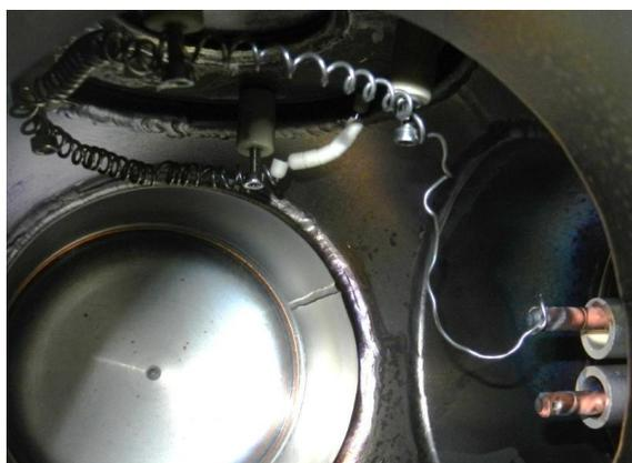
**Figura 6.2** Interno della camera da vuoto con collegamento del filamento al passante isolato
