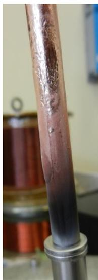
**Figura 4.11** Catodo parzialmente fuso dopo il processo
