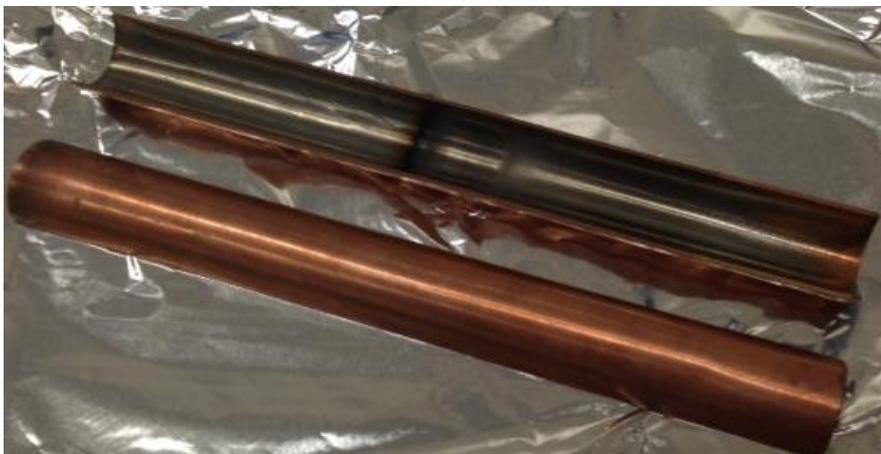
**Figura 5.29** *Tubo di rame con visibili segni di contatto con la wing inferiore del catodo*
