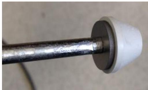
**Figura 5.31** Immagine dell'isolatore in BN avvitato alla wing inferiore
