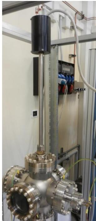
**Figura 6.15** Rendering 3D e fotografia del Magnetron planare regolabile in altezza
