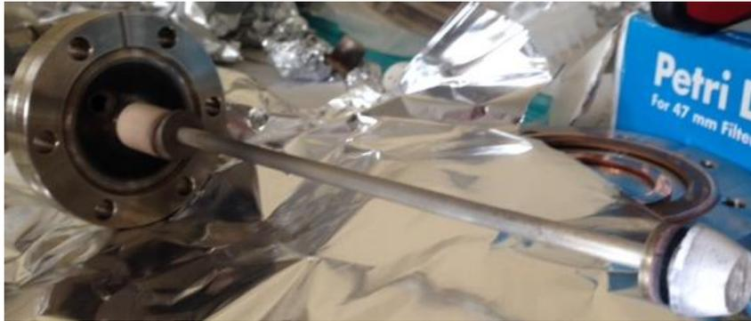
Figura 5.60 Fotografia del target di Niobio inquinato dopo il processo
