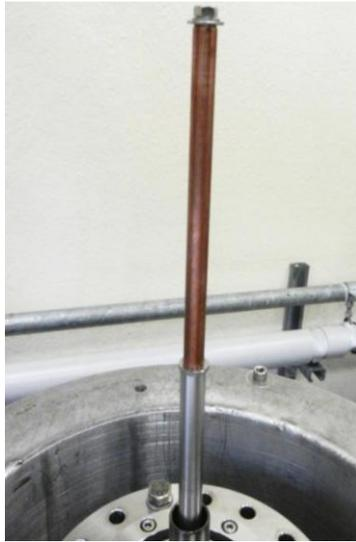
**Figura 4.10** Foto relativa al catodo con montate le nuove wings di diametro inferiore
