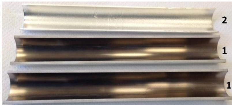
**Figura 5.38** Substrato di alluminio con ricoprimento di Niobio(2) a confronto con una metà non ancora depositata (1)
