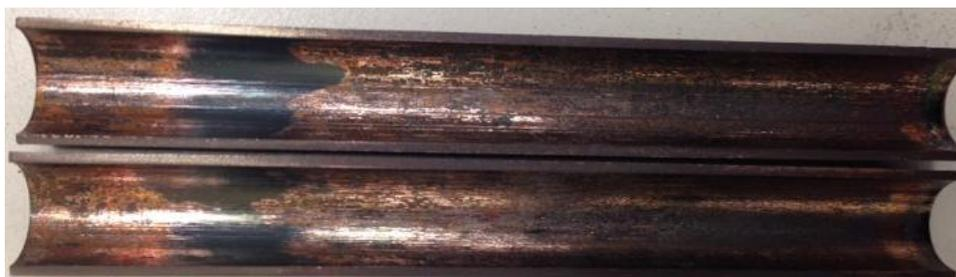
**Figura 5.55** *Substrato di Rame ottenuto a causa della rottura di una saldatura*
