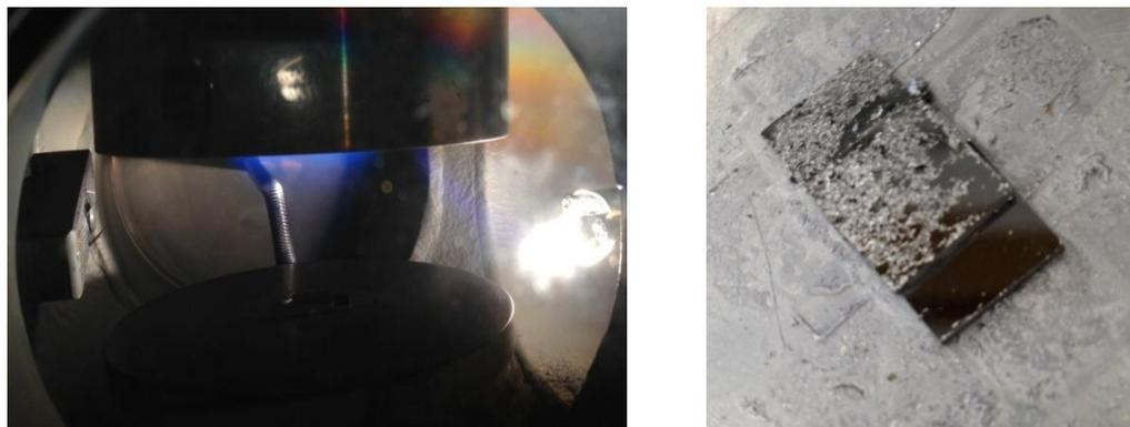
**Figura 6.20** Magnetron Sputtering con filamento e substrati post-processo delaminati
