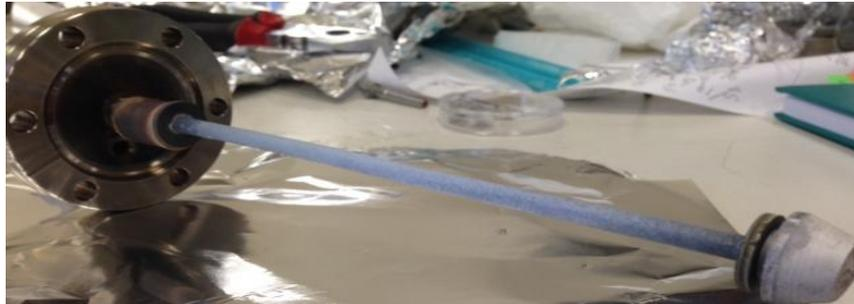
**Figura 5.56** *Fotografia del catodo dopo la rottura; esso si presenta di colore bianco molto probabilmente perché ha subito un'ossidazione termica*
