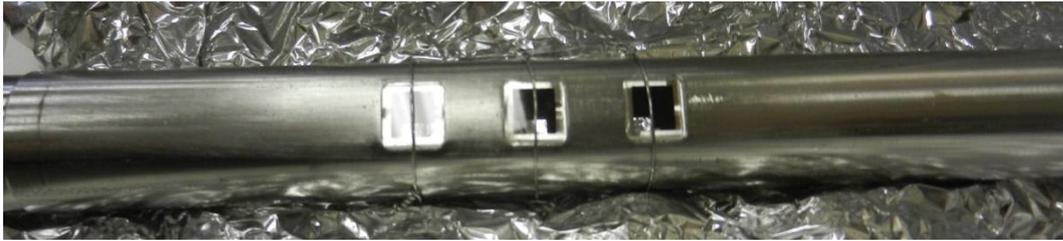
**Figura 4.14** Substrati di quarzo posizionati nel loro alloggiamento per la deposizione
