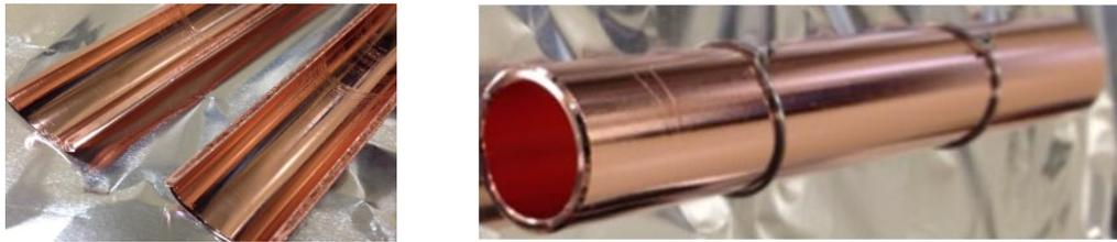
**Figura 5.34** Immagini del tubo di rame tagliato, lucidato con metodo Subu e avvolto da filo metallico per la deposizione
