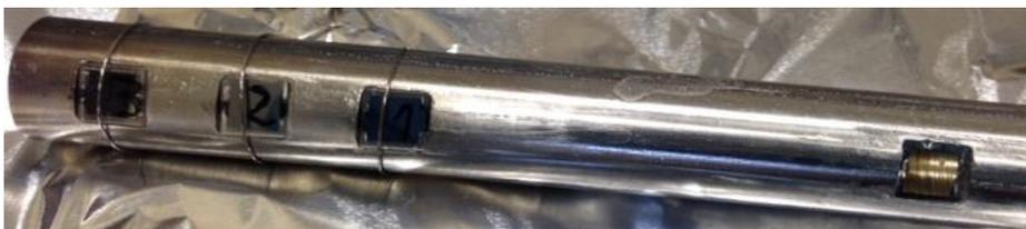
**Figura 5.48** Modifica effettuata sul tubo portaquarzi, ora con 8 alloggiamenti
