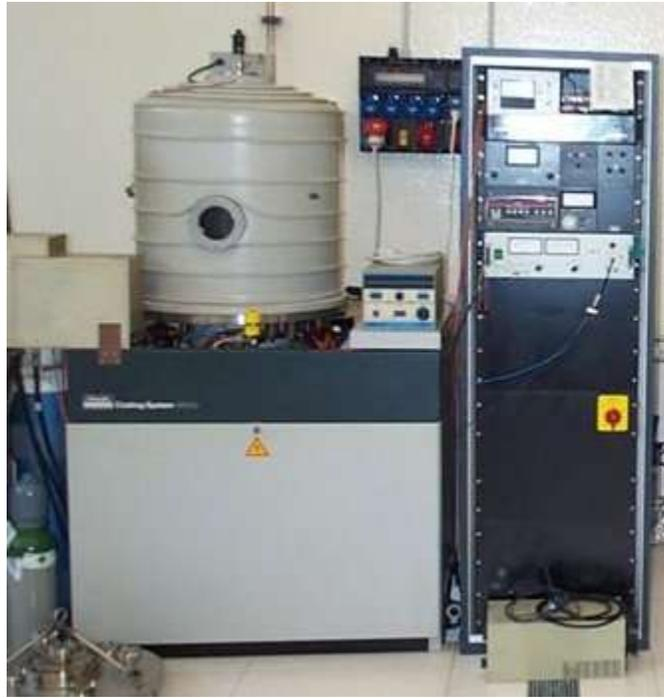
*Foto 1 Macchina utilizzata per le deposizioni*
